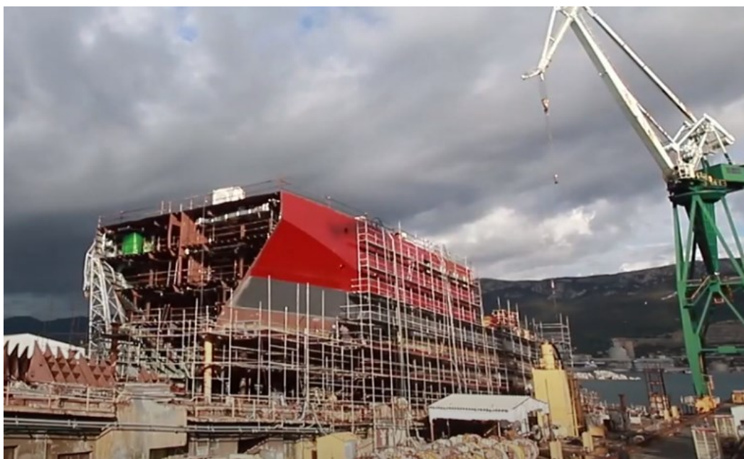
Slika 6.1.1. Montaža broskog trupa na navozu (Brodosplit)
