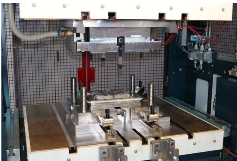
Slika 3.1. Hidraulična preša sa grijanim alatom
