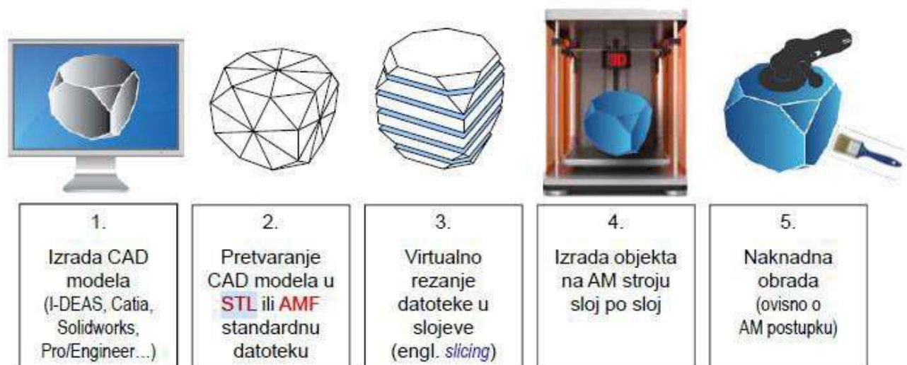
Slika 2.1. Postupak dobivanja predmeta od 3D modela do gotovog proizvoda
