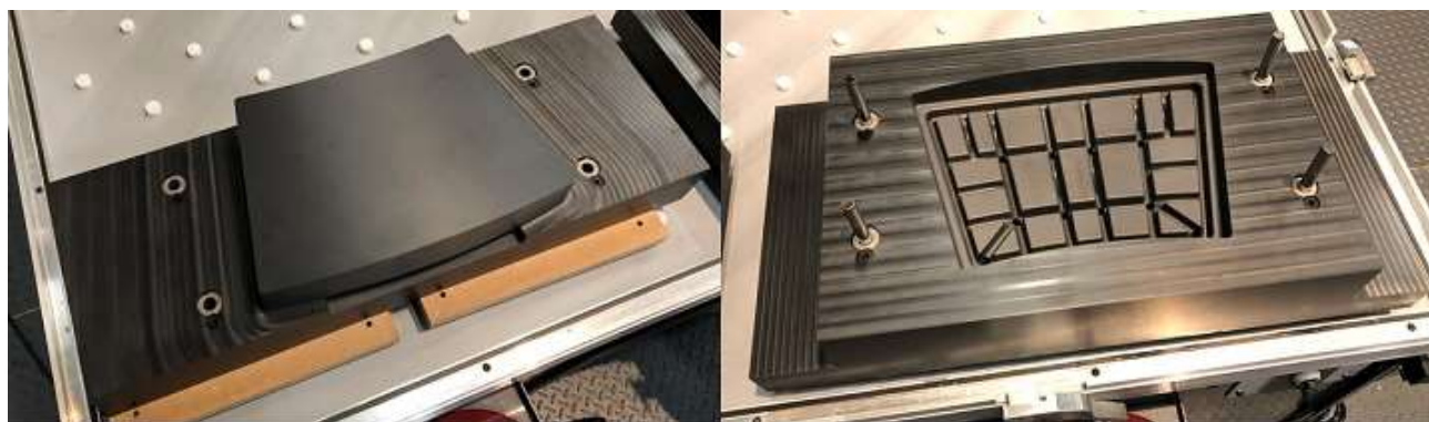
Slika 3.2. Alat izrađen od kompozitnih materijala aditivnom tehnologijom
