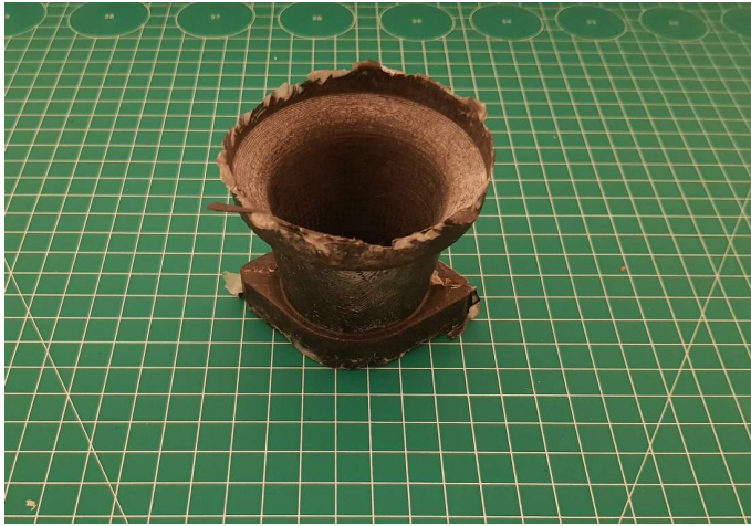
Slika 5.7. Izradak neposredno nakon vađenja iz alata
