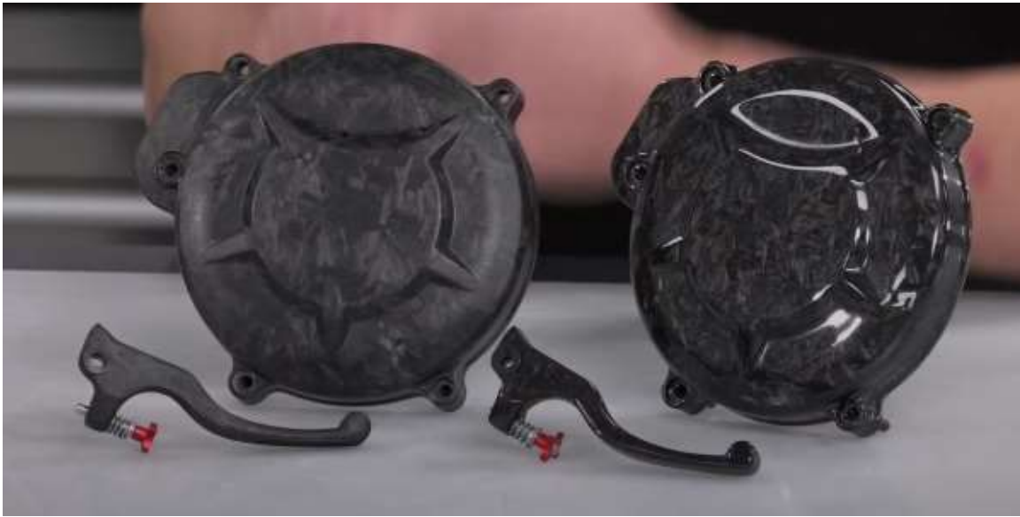
Slika 3.5. Poklopac i ručica kvačila od motocikla
