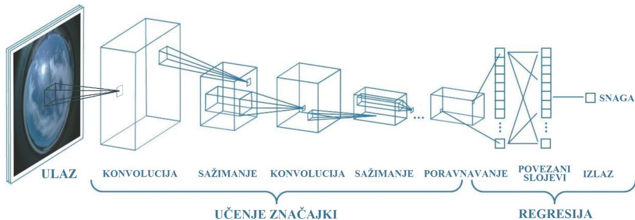
Slika 19: Struktura tipične konvolucijske neuronske mreže
