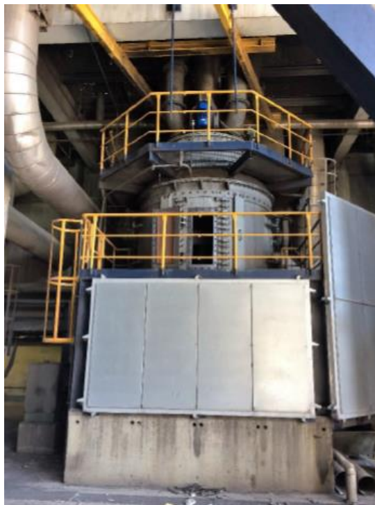
Slika 12. Mlin za usitnjavanje ugljena [5]
