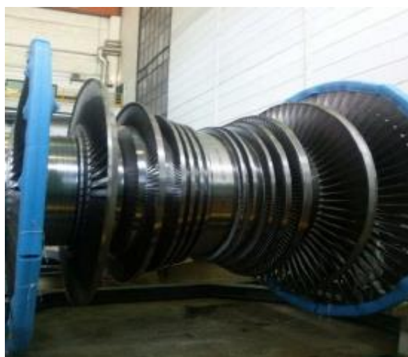
Slika 14. Niskotlačni dio parne turbine [5]
