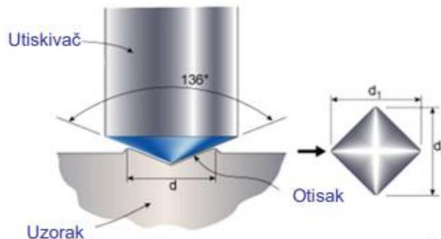
Slika 7.4. Princip mjerenja po Vickersu [13]
