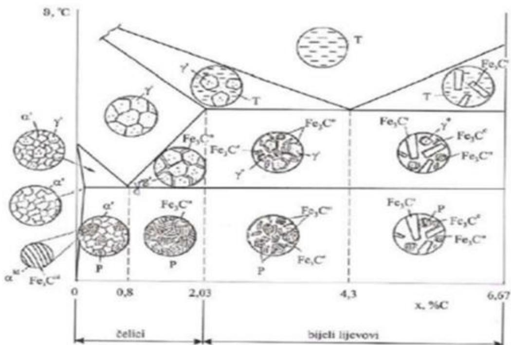
Slika 3.1. Mikrostrukture čelika ovisno o postotku ugljika i temperature zagrijavanja [2]
