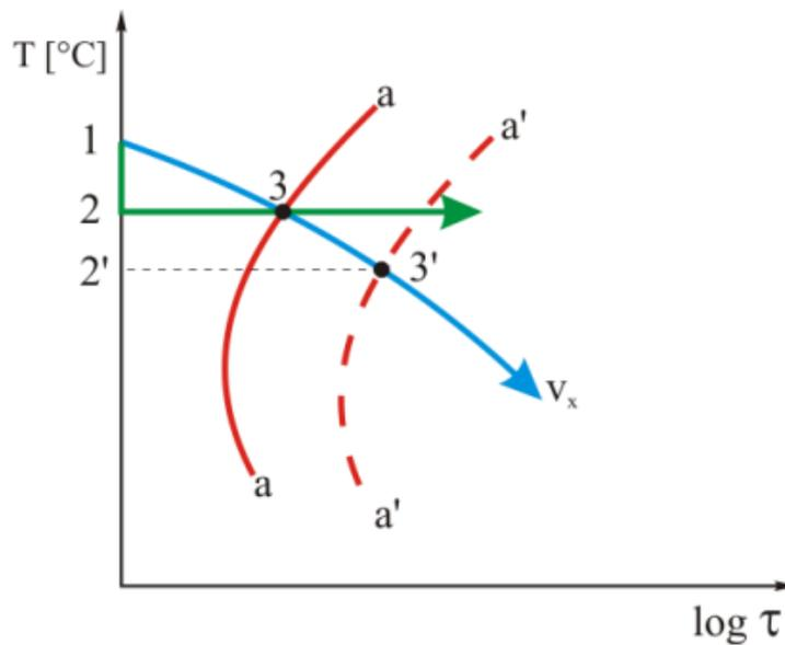
*Slika 6.4. Pomicanje linije pretvorbe TTT- dijagrama pri prijelazu s izotermičkog na kontinuirano hlađenje [11]*
