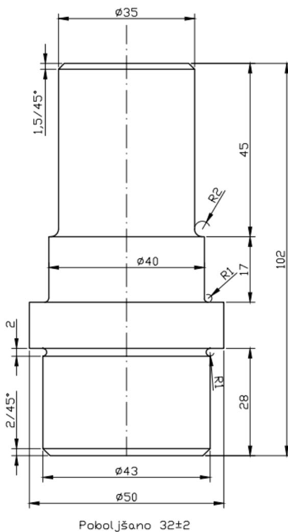
Slika 9.1. Nacrt strojnog dijela JI.23 – ST.18
