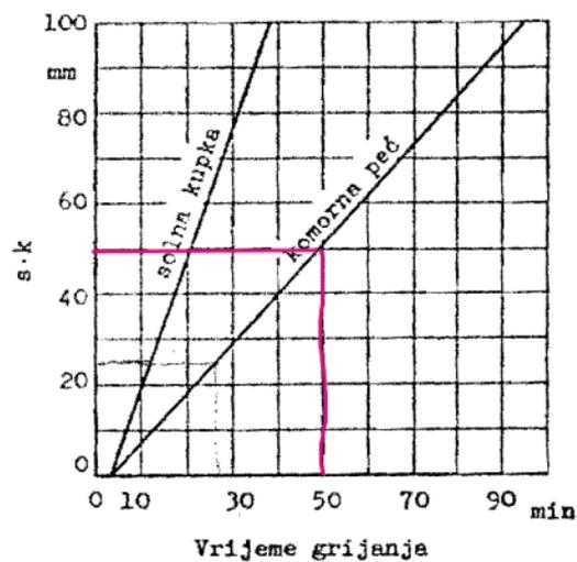
Slika 9.2. Očitavanje vremena grijanja u zavisnosti od „s · k“ [6]
