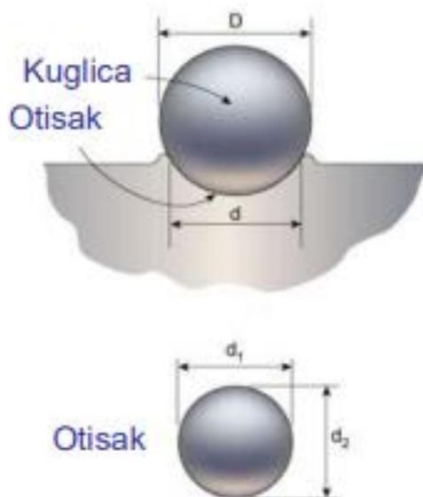
Slika 7.2. Princip mjerenja tvrdoće po Brinellu [13]
