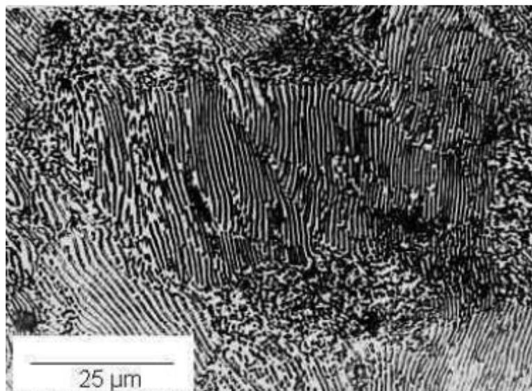
*Slika 3.4. Perlitna mikrostruktura [5]*
