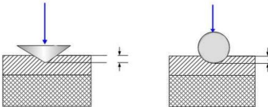
Slika 7.1. Dijamanтни stožac i kuglica od kaljenog čelika [13]
