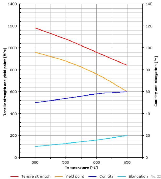
Slika 9.3. Dijagram ovisnosti mehaničkih svojstava o temperaturi popuštanja za čelik 42CrMo4 [14]
