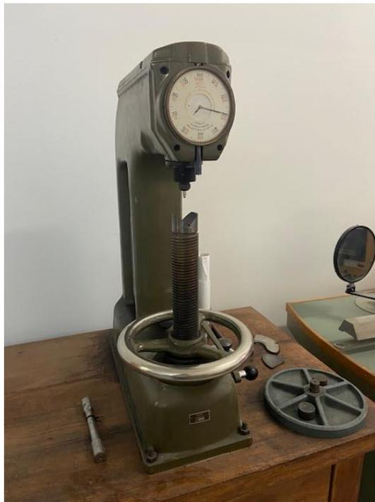
*Slika 9.7. Uređaj za mjerenje tvrdoće (HRC)*
