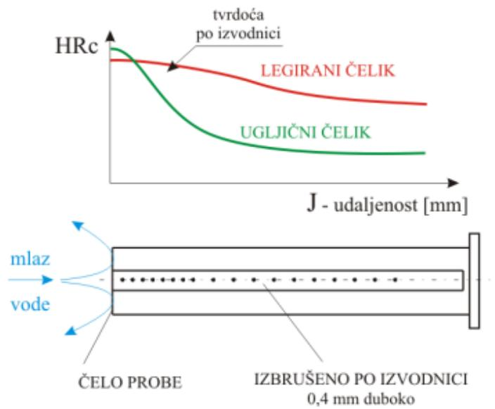
Slika 5.5. Ispitivanje prokaljivosti po Jominyju [11]
