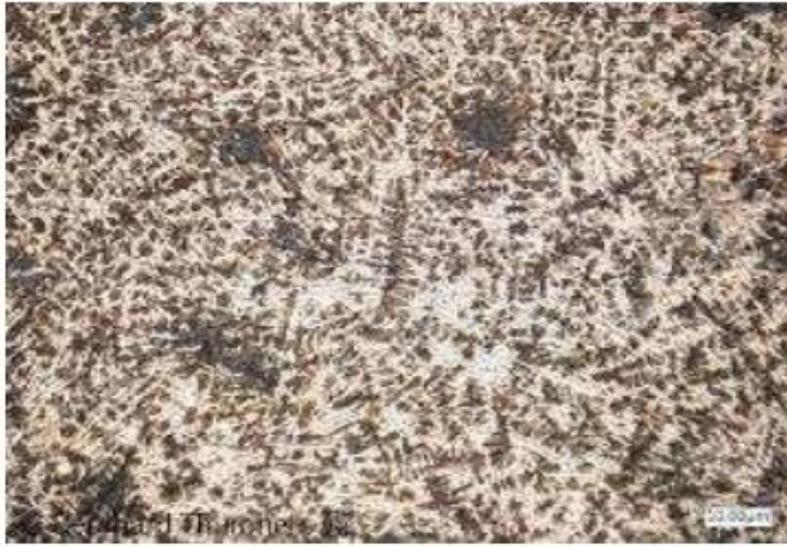
*Slika 3.8. Ledeburitna mikrostruktura [5]*
