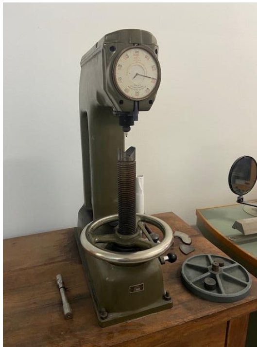
Slika 9.7. Uređaj za mjerenje tvrdoće (HRC)
