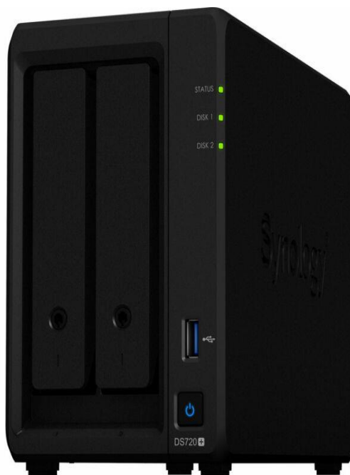
Slika 2.14.: NAS uređaj – omogućava reprodukciju multimedije [12]
