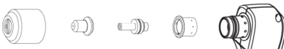
Slika 2.10 Komponente plazma gorionika (s lijeva: zaštitna kapa, mlaznica, katoda, prsten za vrtloženje, tijelo gorionika)
