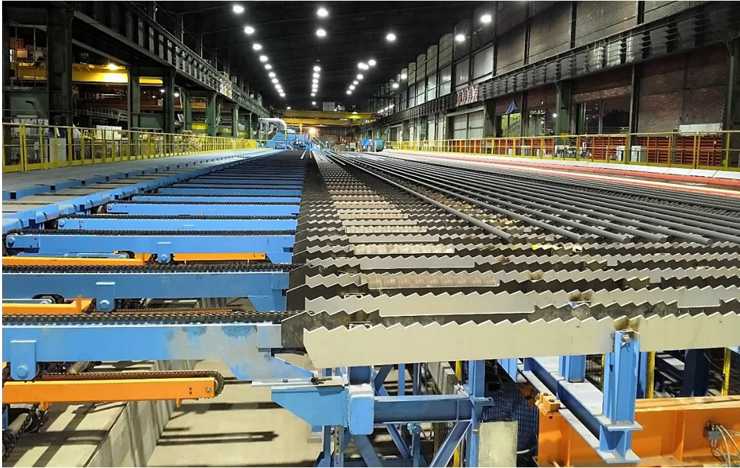
Slika 3.6. Podij za hlađenje materijala [autor]
