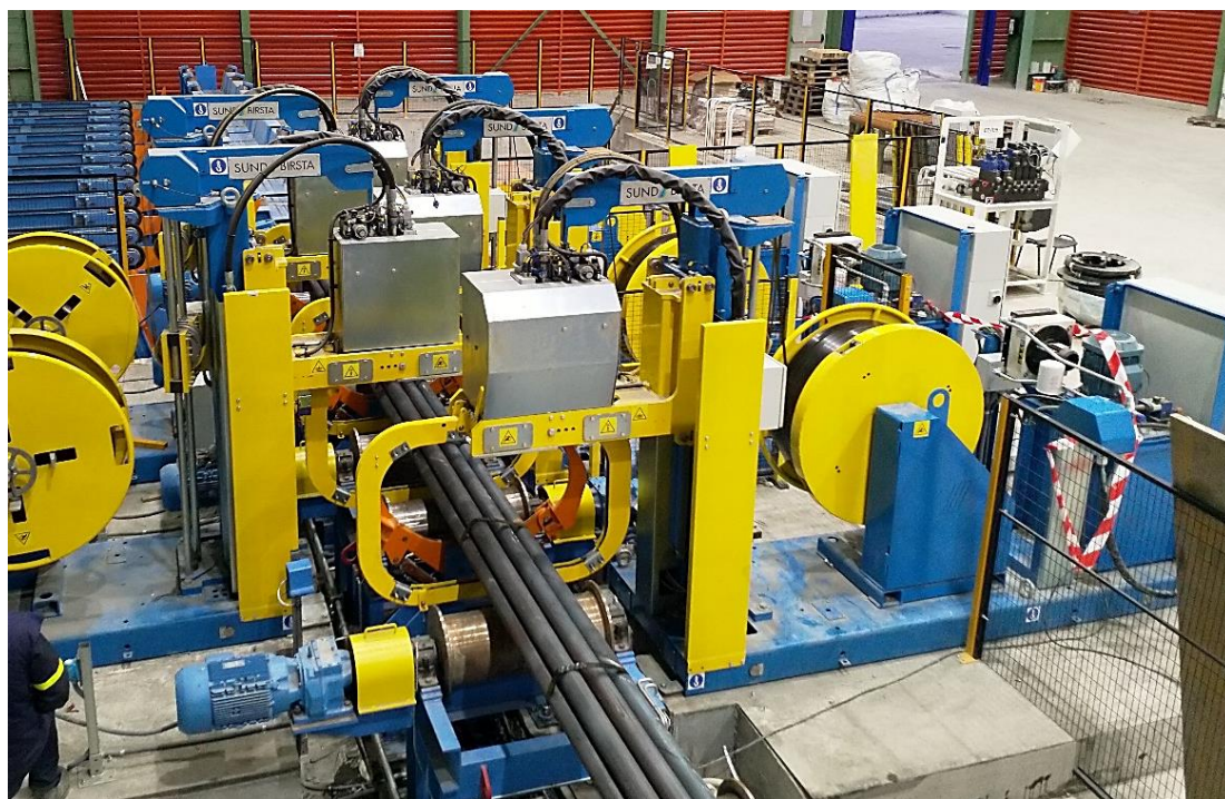
Slika 3.9. Vezalice za formiranje snopova [autor]
