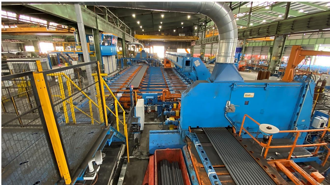
Slika 3.7. Pila za rezanje materijala [autor]
