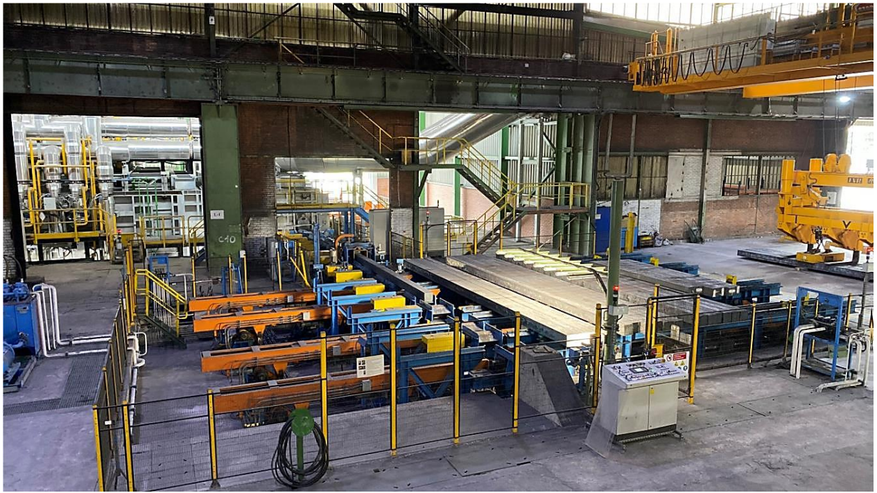
Slika 3.1. Slika rešetke za punjenje peći [autor]
