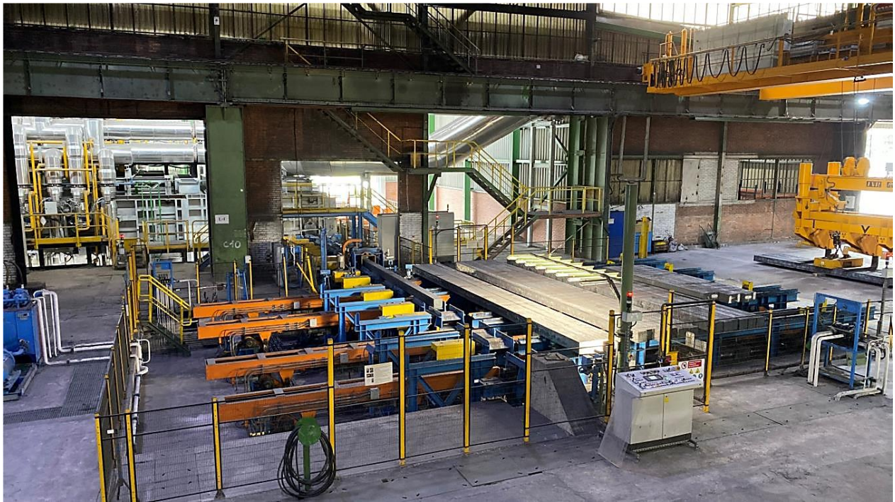
Slika 3.1. Slika rešetke za punjenje peći [autor]
