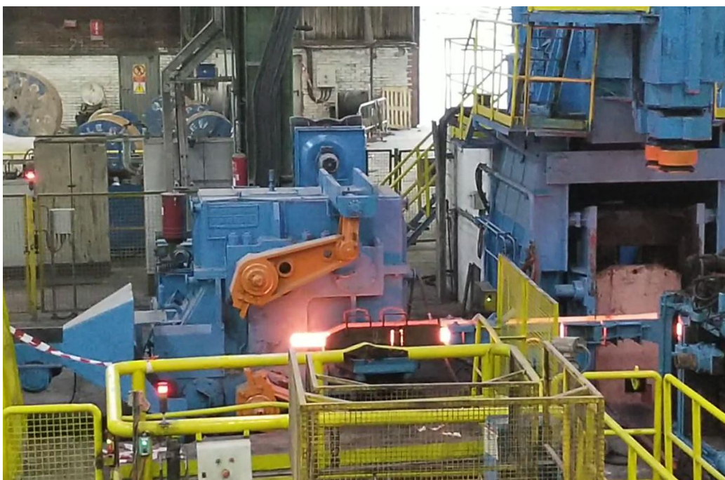
Slika 3.5. Škare za rezanje materijala [autor]
