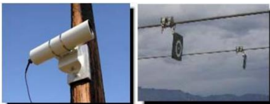
Slika 5.12. Prikaz kamere (lijevo) i mete na vodu (desno) [11]
