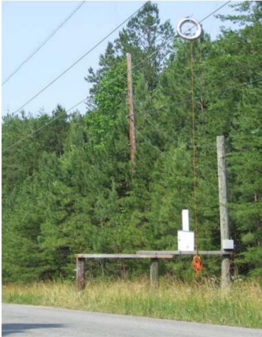
Slika 5.14. Prikaz DGPS metode mjerenja provjesa [41]
