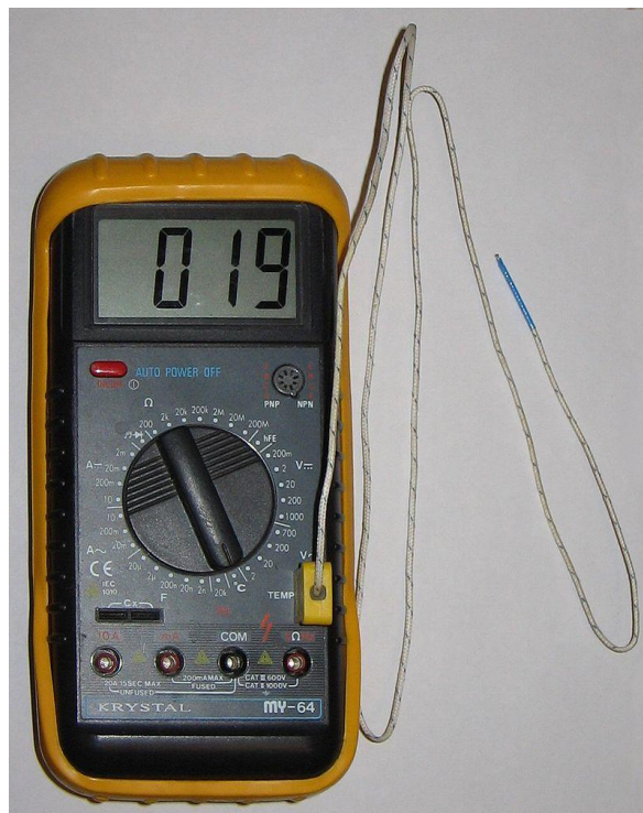
Slika 5.3. Termopar spojen na multimeter koji pokazuje temperaturu u °C [19]
