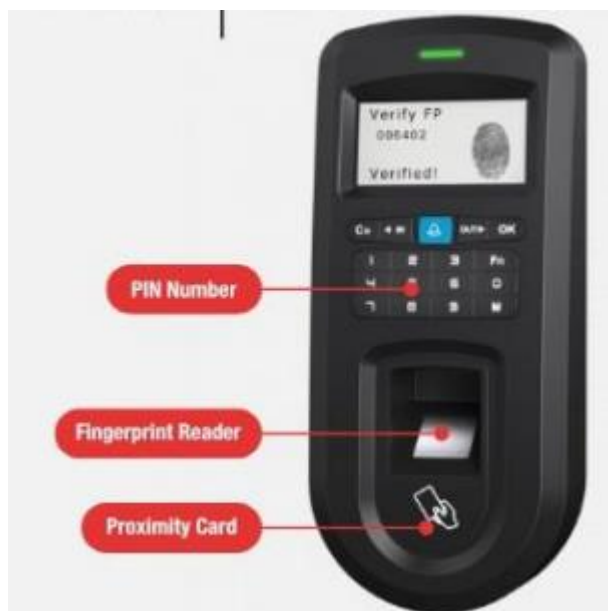
Slika 3.2. Uređaj sa više mogućnosti autentifikacije [17]
