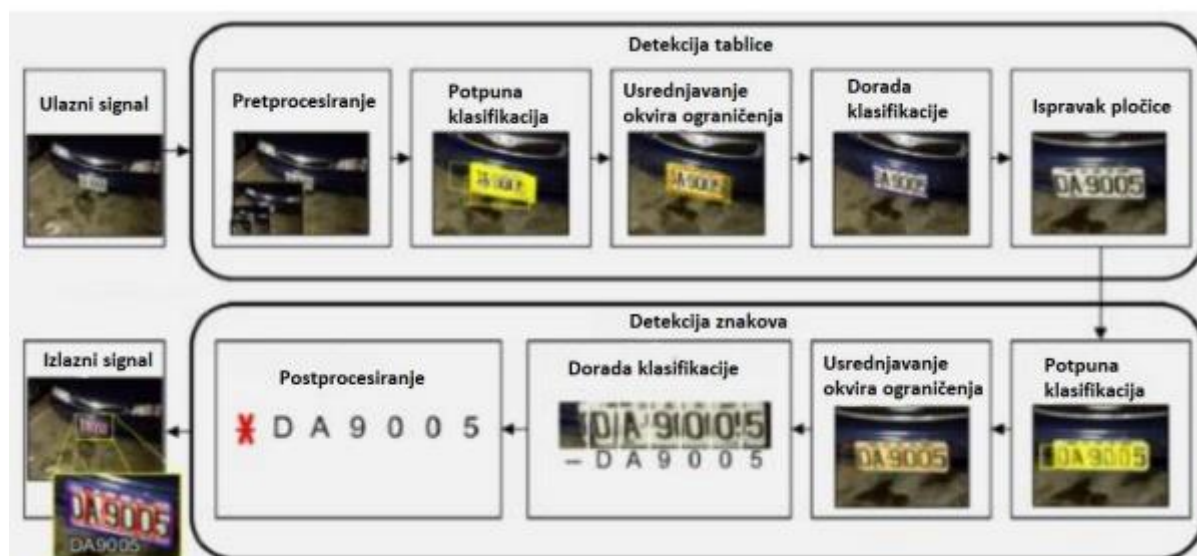
Slika 4.2. Proces detekcije tablice putem dubokog učenja [64]
