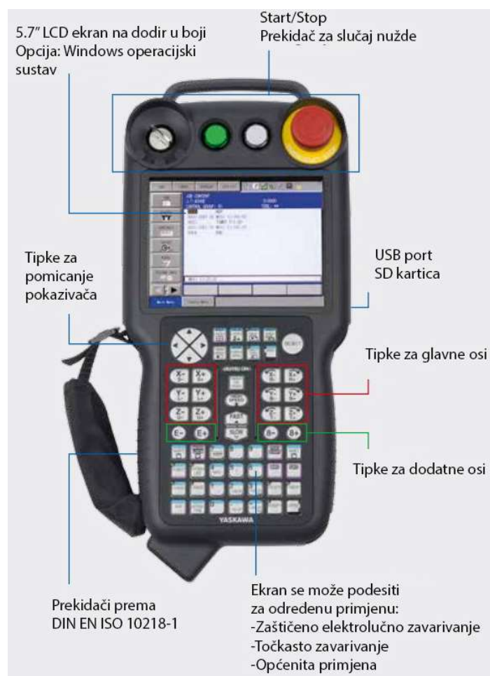
Slika 3.12. PHG (ručna programska jedinica) i funkcije tipki [31].
