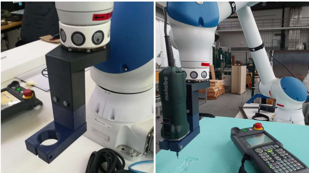
Slika 4.10. Montiranje prihvatnice i Metabo motor-vretena.
