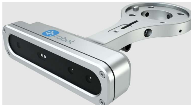
Slika 3.22. Modul „vida“ (kamera) tvrtke OnRobot [42].
