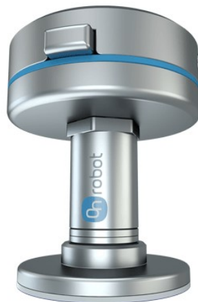
Slika 3.17. Hvataljka s ljepljivom površinom tvrtke OnRobot [37].
