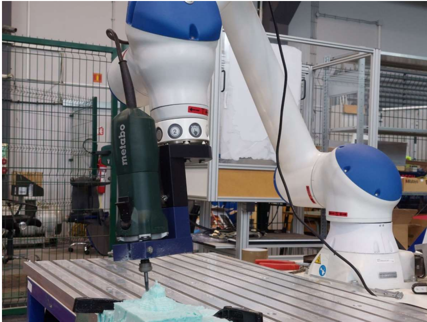
Slika 4.64. Stezanje sirovca i proces grube obrade.
