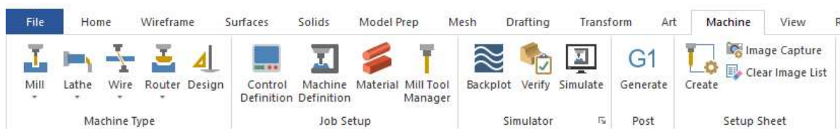
Slika 4.16. Mogući načini obrade korištenjem Mastercam-a.
