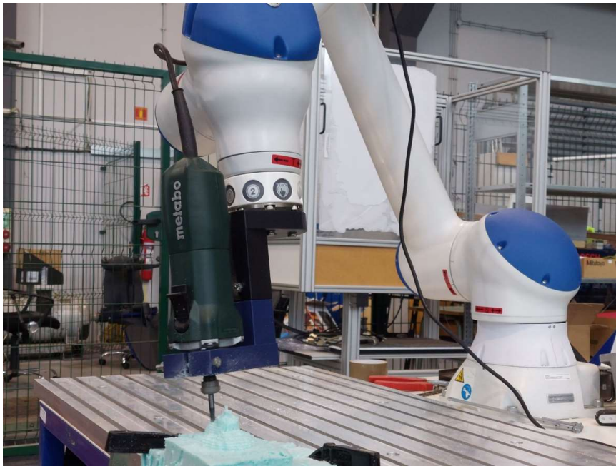
Slika 4.64. Stezanje sirovca i proces grube obrade.
