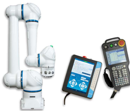
Slika 3.3. Robotska ruka Yaskawa MOTOMAN HC10DT.
