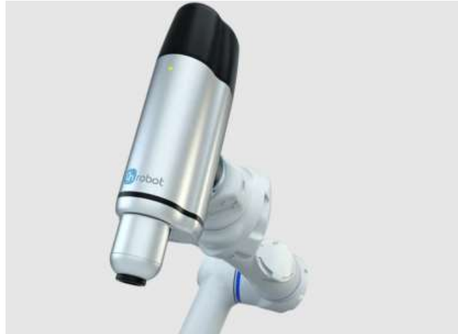
Slika 3.20. Modul koji obavlja spajanje vijčanim spojem [40].
