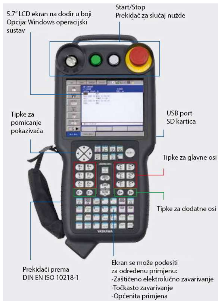
Slika 3.12. PHG (ručna programska jedinica) i funkcije tipki [31].
