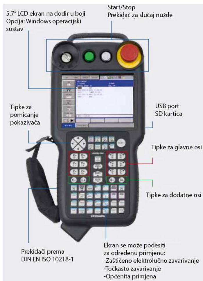
Slika 3.12. PHG (ručna programska jedinica) i funkcije tipki [31].
