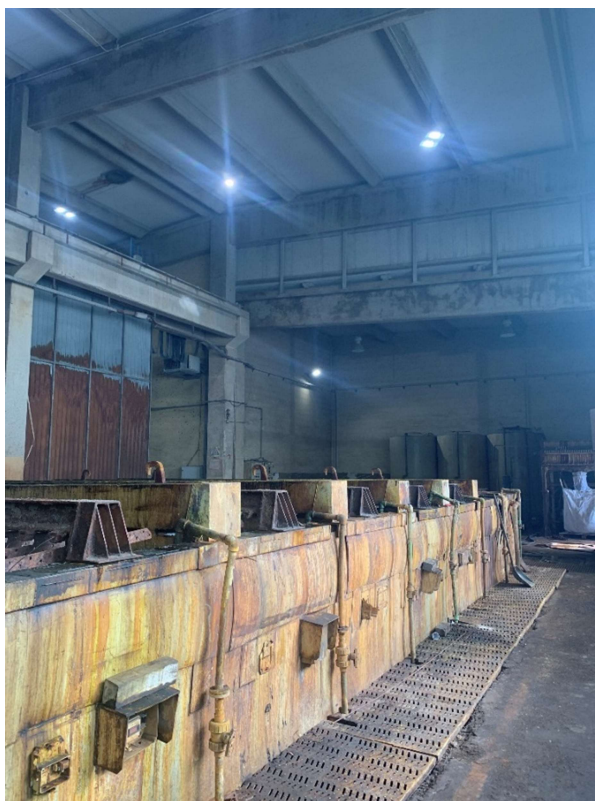
Slika 6.1: Bazeni za pripremu i čišćenje površine
