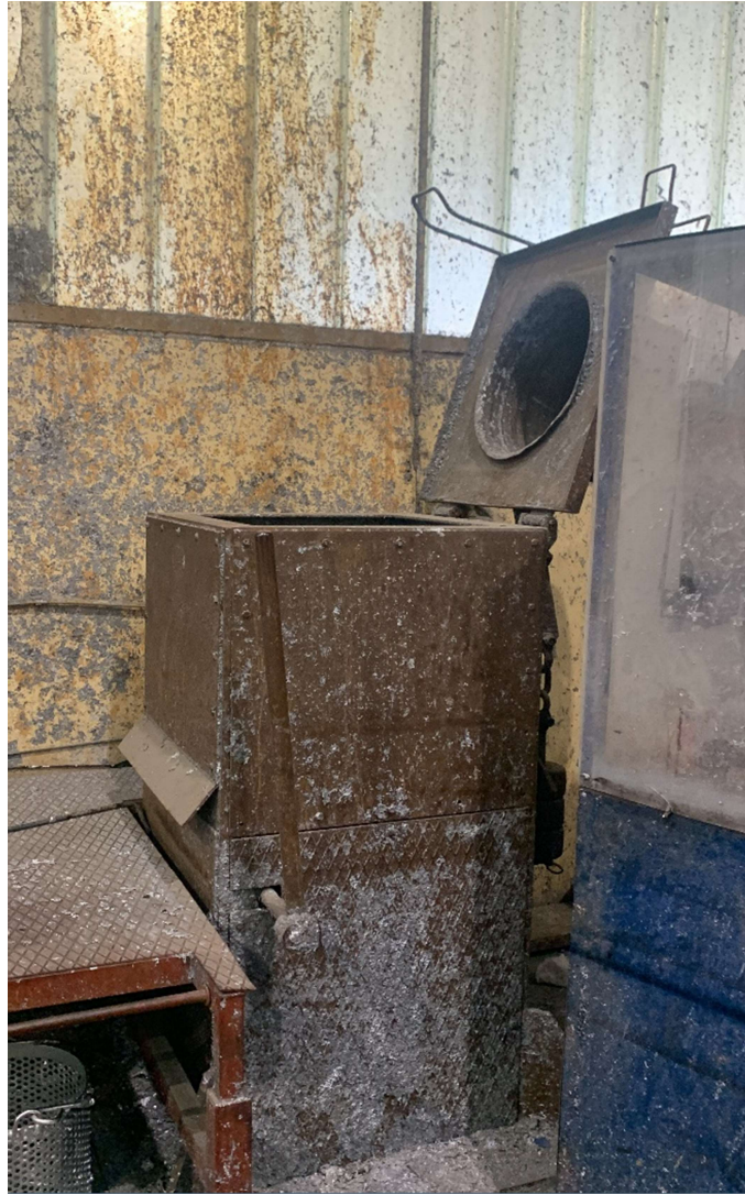
Slika 6.8: Bubanj za centrifugu
