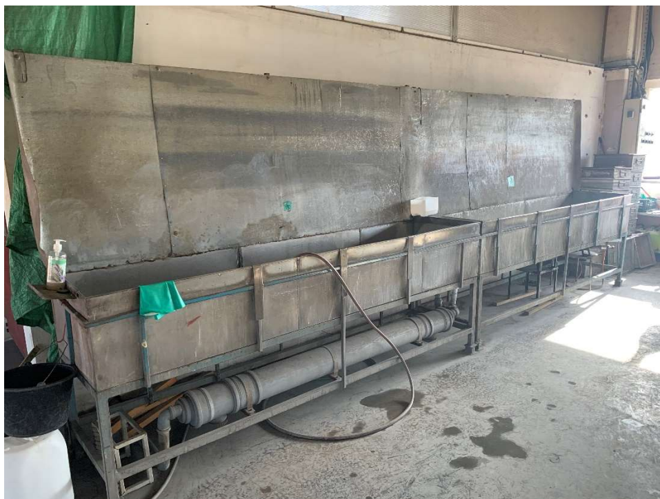
Slika 6.10: Kada za odmašćivanje i fosfatiranje
