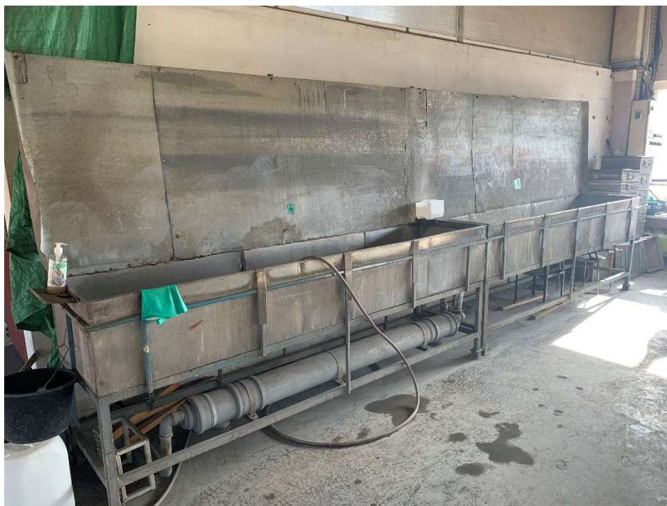
Slika 6.10: Kada za odmašćivanje i fosfatiranje
