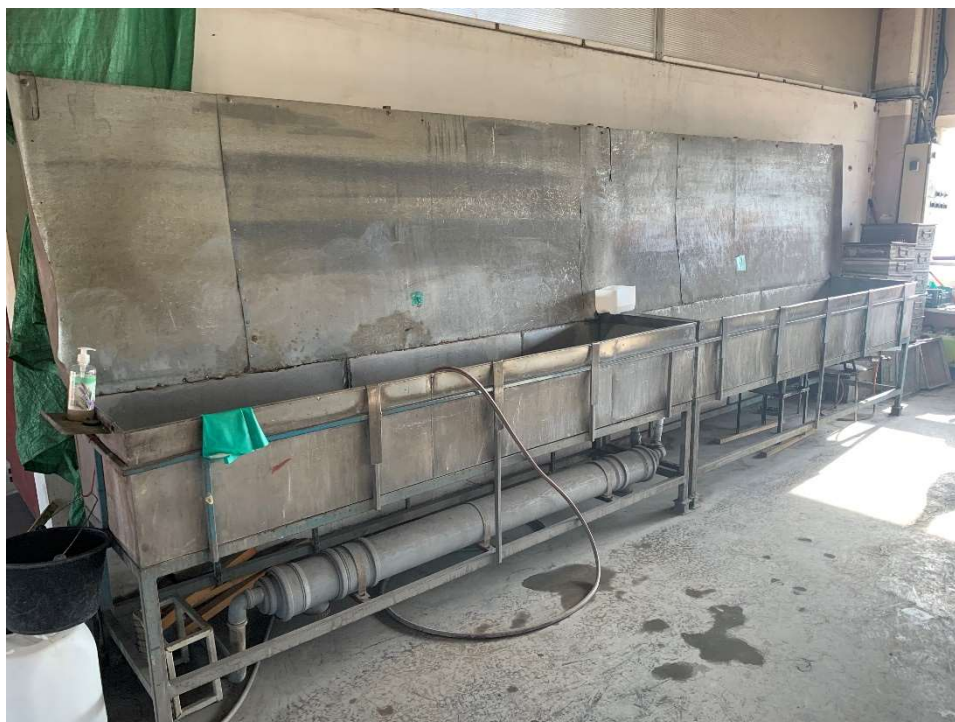
Slika 6.10: Kada za odmašćivanje i fosfatiranje
