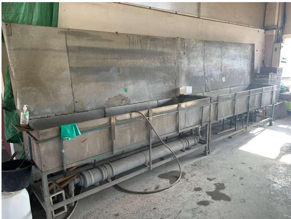
Slika 6.10: Kada za odmašćivanje i fosfatiranje
