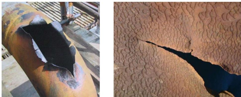
Slika 4.10: Erozijsko oštećenje cjevovoda za transport nafte [10]
