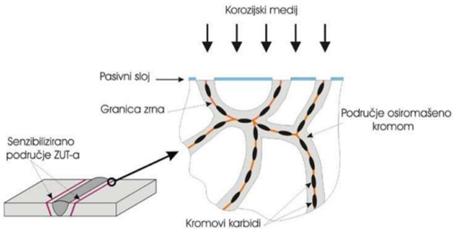
Slika 4.7: Nastajanje interkristalne korozije kod zavarenog spoja [11]
