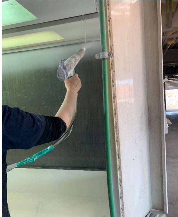
*Slika 6.12: Postupak nanošenja praha*
