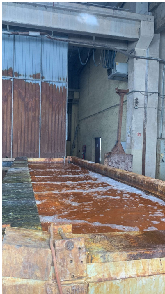
Slika 6.4: Bazen za fluksiranje
