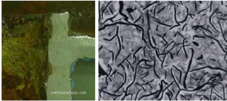
Slika 4.8: Primjer grafitizacije sivog lijeva [11]
