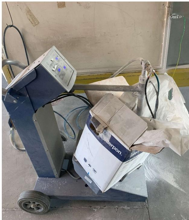
*Slika 6.13: Elektrostatski pištolj i prah*
