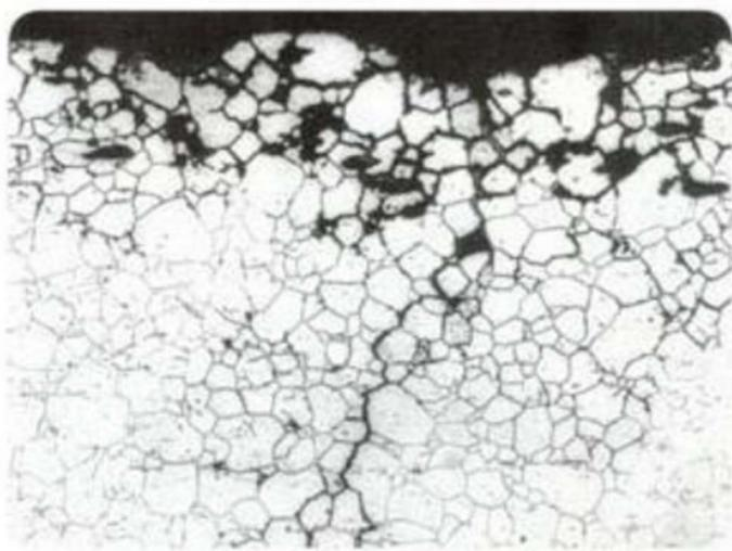
Slika 4.6: Interkristalna korozija austenitnog nehrđajućeg čelika [11]
