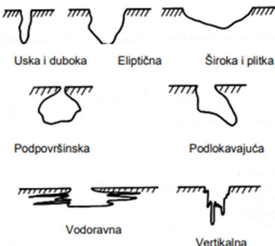
Slika 4.5: Tipovi rupičaste korozije [10]
