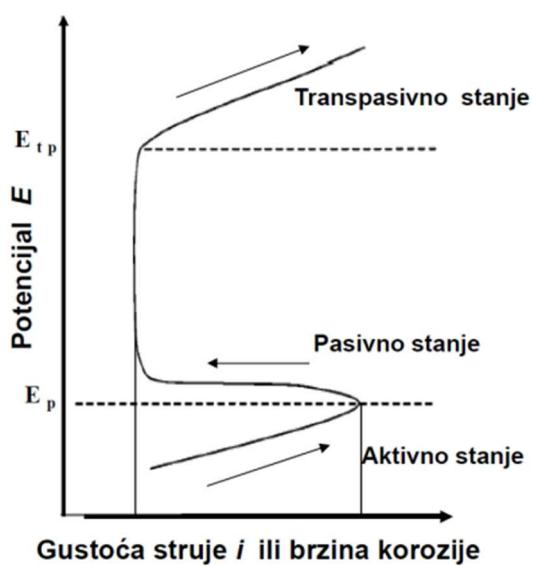
*Slika 3.5: Polarizacijska krivulja anode prilikom pasivizacije [11]*
