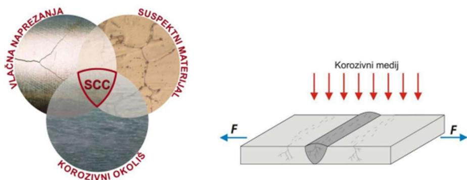
Slika 4.11: Napetosna korozija [10]
