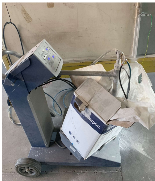
Slika 6.13: Elektrostatski pištolj i prah
