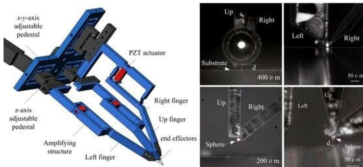
Slika 2.19 Mikrohvataljka za pozicioniranje žice [13]
