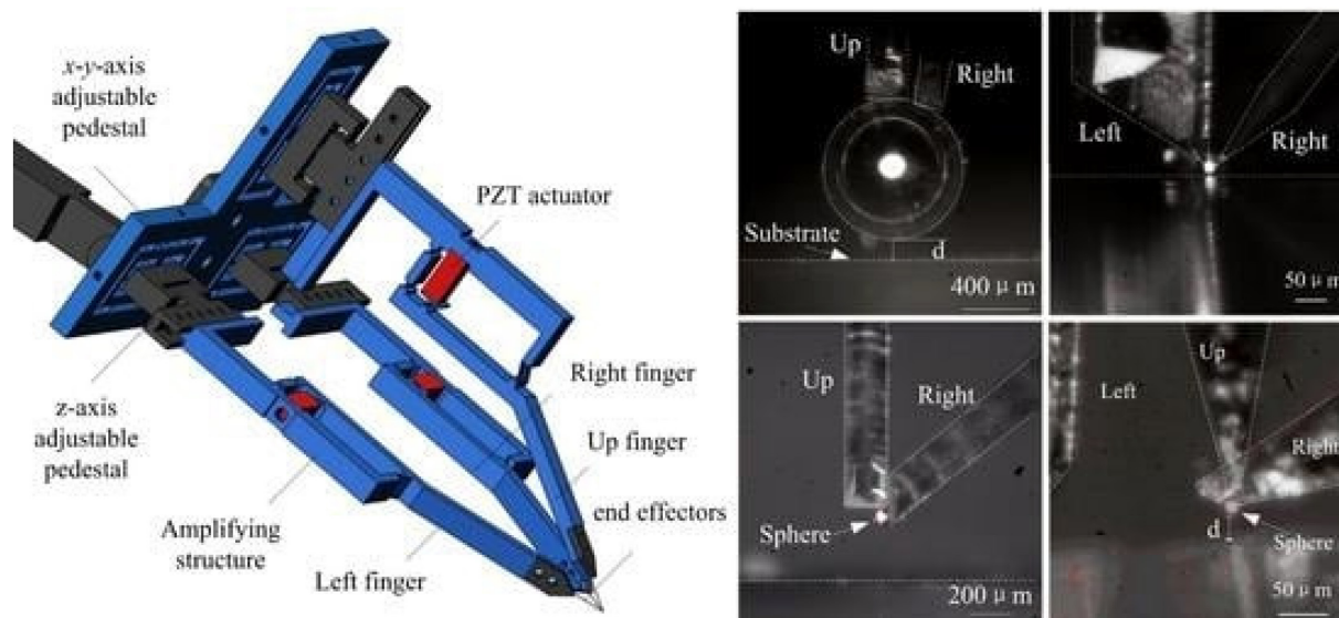
Slika 2.19 Mikrohvataljka za pozicioniranje žice [13]
