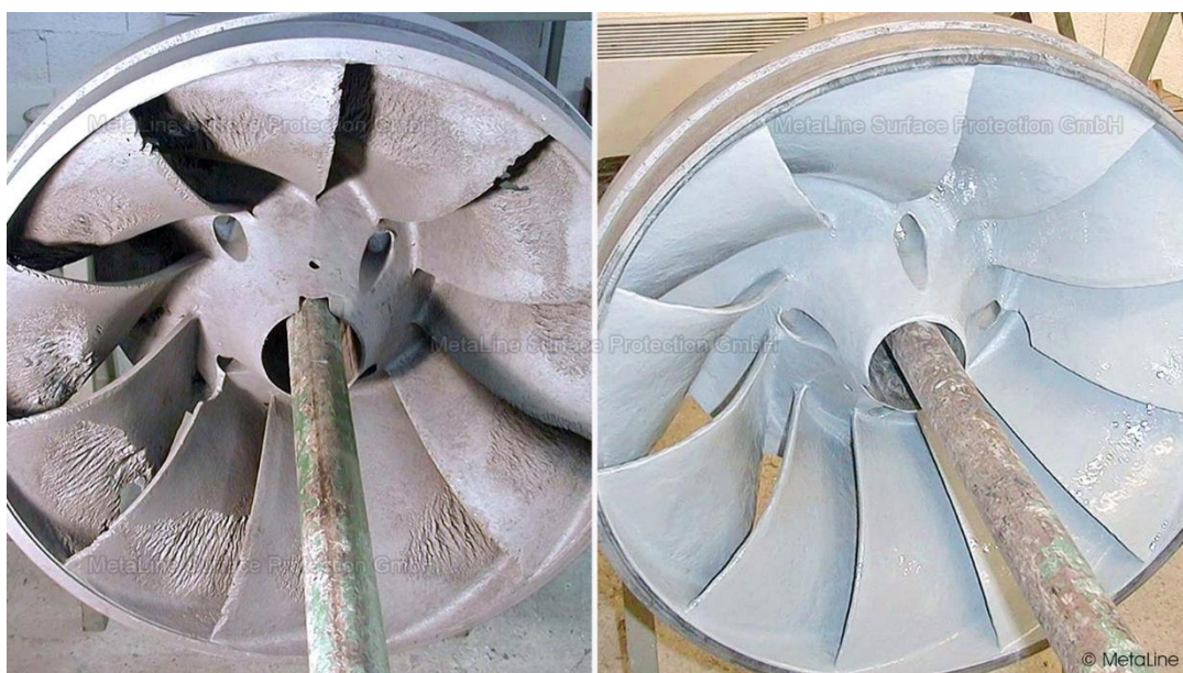
Slika 5.8. Primjer kavitacijske erozije [10]
