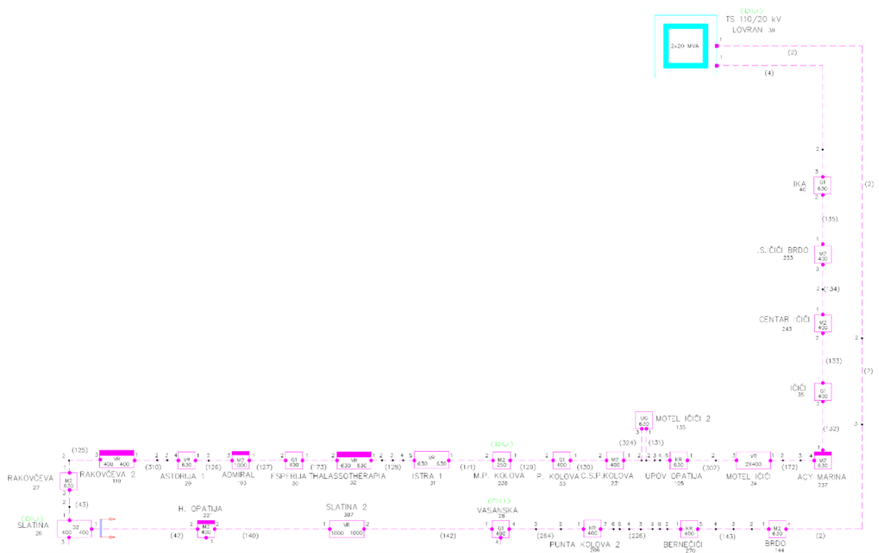
Slika 6.10. Blok shema SN petlje IKA-BRDO [4]
