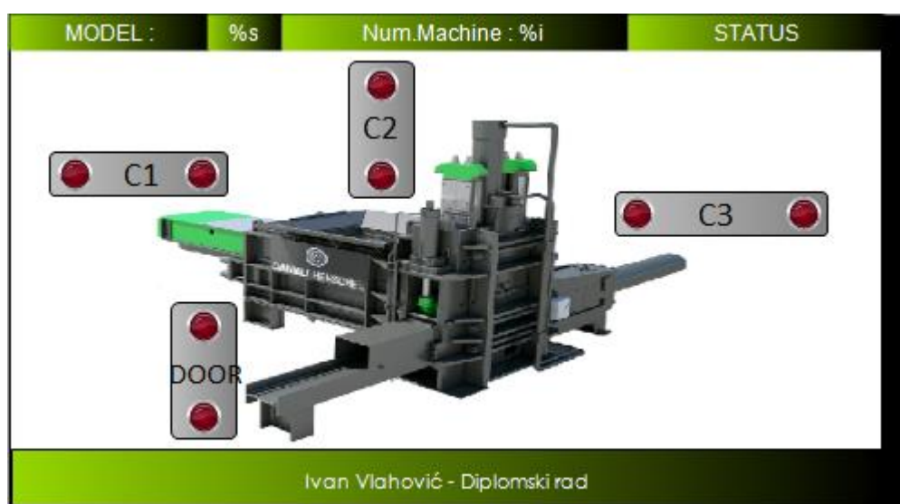
Slika 6.7. Stranica pregleda preše unutar CODESYS-a
