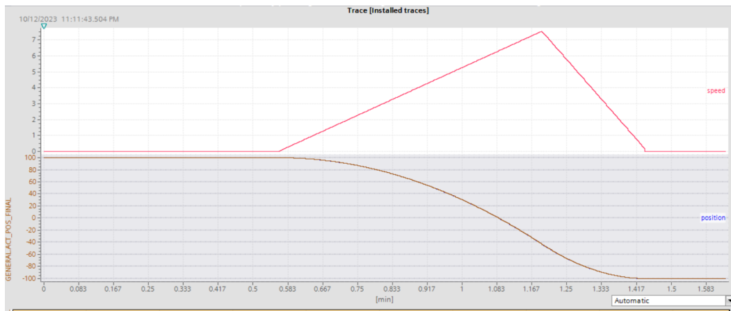
Slika 8.2.1. Pozicioniranje akceleracijom i deceleracijom
