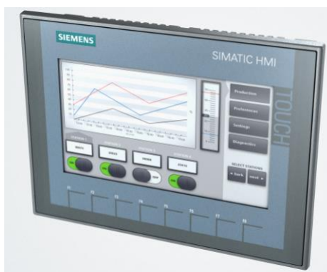
Slika 4.4.1. HMI KP700 Basic PN [11]
