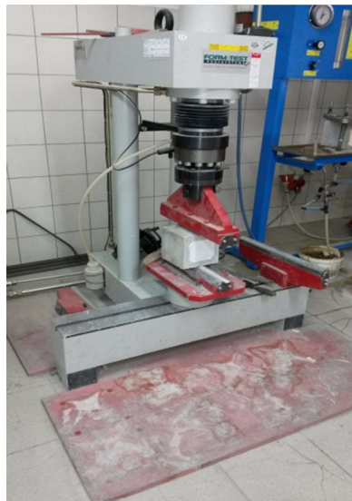
Slika 38 Određivanje vlačne čvrstoće betona
