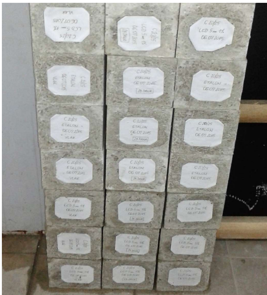
Slika 35 Betonske testne kocke u vlažnoj komori
