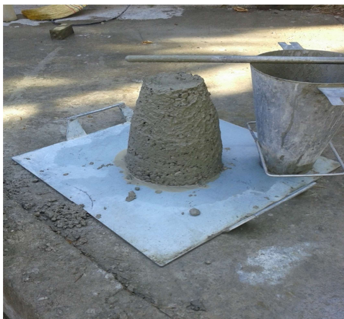
Slika 34 Kalup za mjerenje konzistencije betona i uzorak
