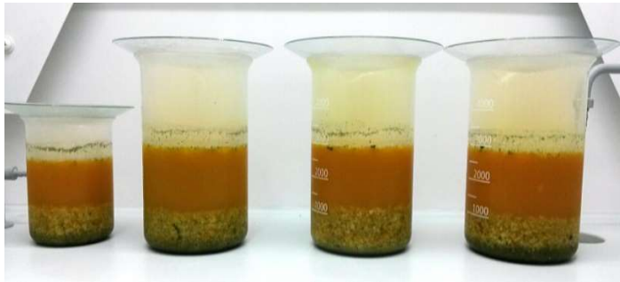
Slika 20 Uzorak LCD-a u zlatotopci nakon 48 sati
