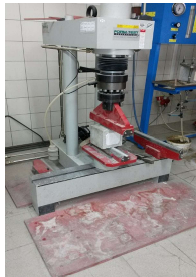
Slika 38 Određivanje vlačne čvrstoće betona
