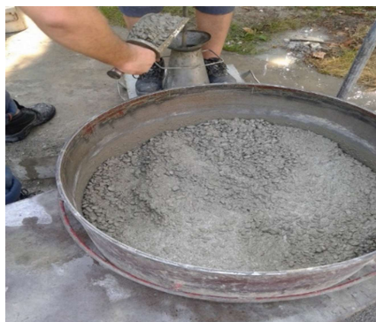
Slika 30 Betonska mješavina s 1% zamjene otpadnog LCD 10
