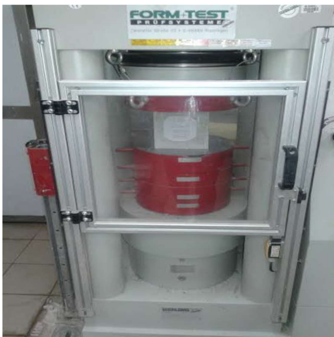
Slika 36 Uređaj za ispitivanje tlačne čvrstoće betona
