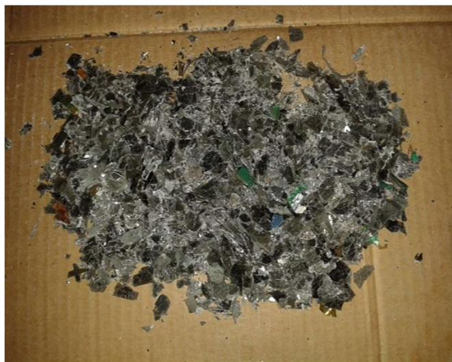
Slika 17 Usitnjeni LCD zasloni na 10 mm
