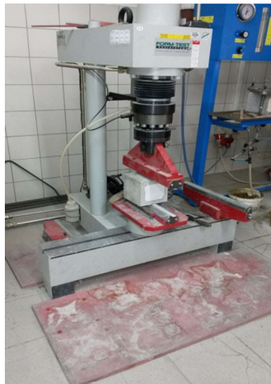
Slika 38 Određivanje vlačne čvrstoće betona
