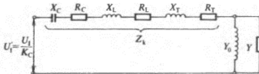
*Slika 3.28. Nadomjesna shema kapacitivnog transformatora [7]*
