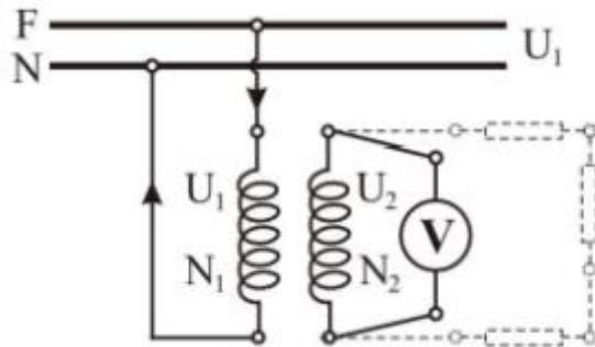
*Slika 3.16. Spajanje naponskog transformatora na mrežu [14]*
