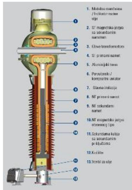
*Slika 3.32. Presjek kombiniranog mjernog transformatora tipa VAU [23]*
