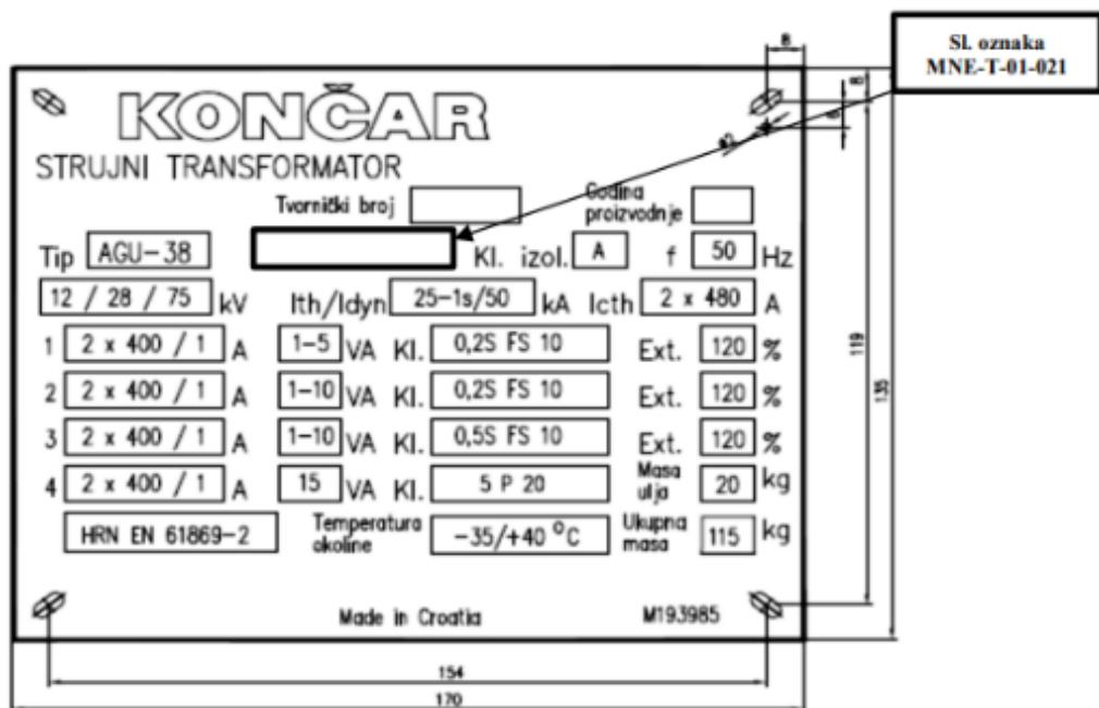
Slika 5.1. Natpisna pločica strujnog mjernog transformatora [27]
