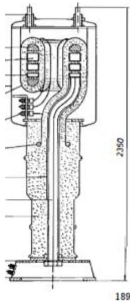
*Slika 3.9. Eposkidni strujni transformator za nazivni napon 110 kV za unutarnju montažu* [2]
