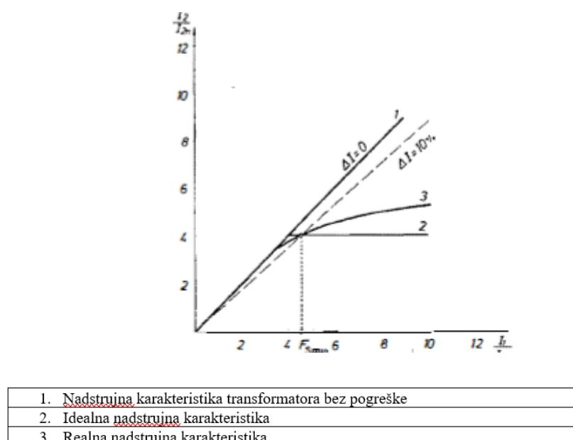
Slika 4.1. Nadstrujna karakteristika strujnog transformatora [2]
