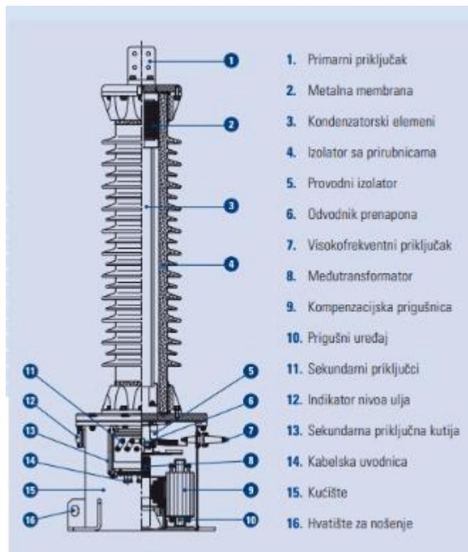
Slika 3.29. Kapacitivni mjerni transformator izoliran papirno uljnom izolacijom [21]
