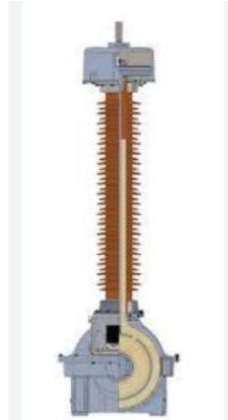
Slika 3.25. Visokonaponski zatvoreni naponski transformator tip VEOT [19]
