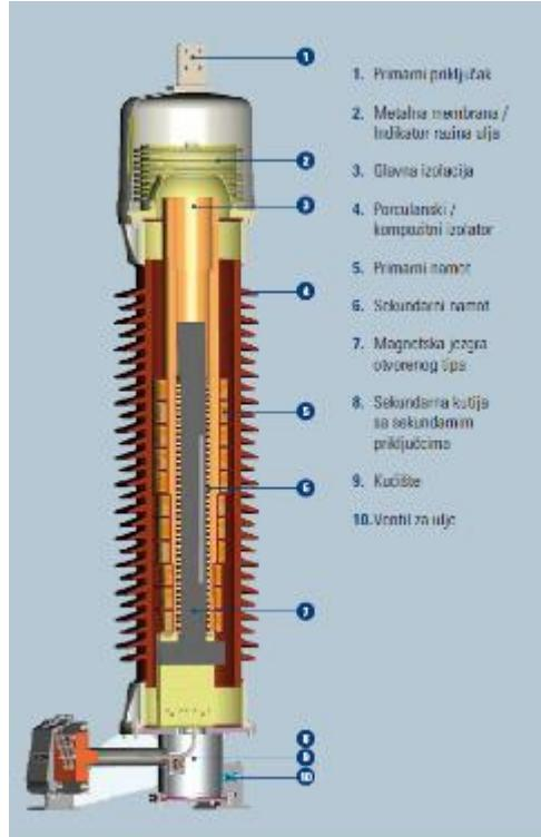
Slika 3.23. Visokonaponski otvoreni induktivni transformator tipa VPU [18]
