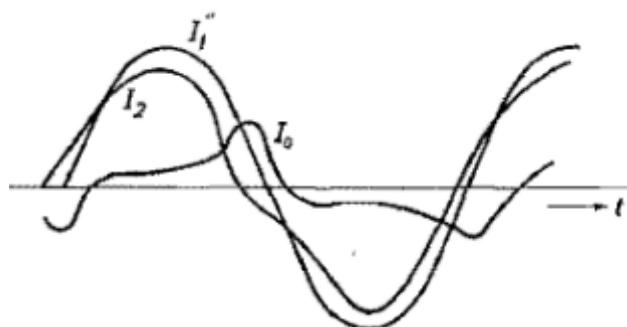
*Slika 4.4. Struje strujnog transformatora kada je jezgra zasićena [2]*
