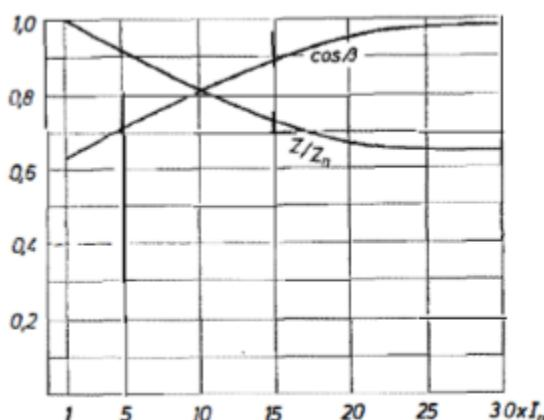
*Slika 4.2. Impedancija i faktor snage induktijskog brojila ovisno o njegovoj struji* [2]
