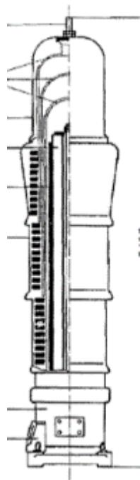
*Slika 3.20. Eposkidni naponski transformator s otvorenom jezgrom 110 kV [2]*
