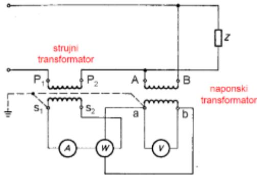
Slika 2.1. Spajanje mjernih transformatora u mjerni krug [3]
