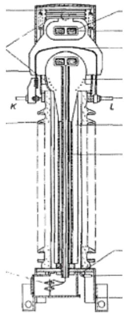
*Slika 3.10. Eposkidni strujni transformator za nazivni napon 220 kV za vanjsku montažu [2]*
