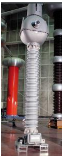
Slika 3.13. Glavata izvedba strujnog transformatora tipa AGU, Končar [12]
