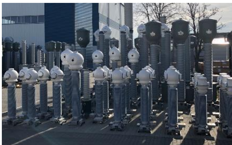
Slika 3.15. Strujni transformatori izolirani SF 6 [13]
