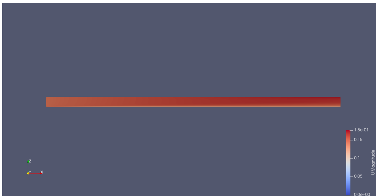
Slika 7.26 Presjek konture brzina ( k - \omega SST model)
