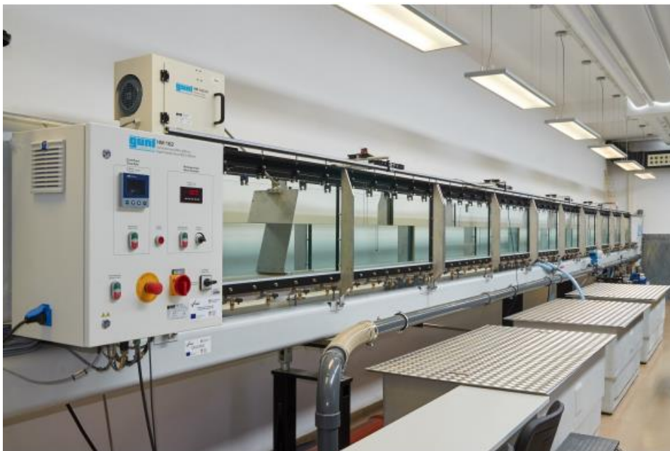
Slika 5.1 Eksperimentalni kanal u hidrotehničkom laboratoriju Građevinskog fakulteta u Rijeci [27]
