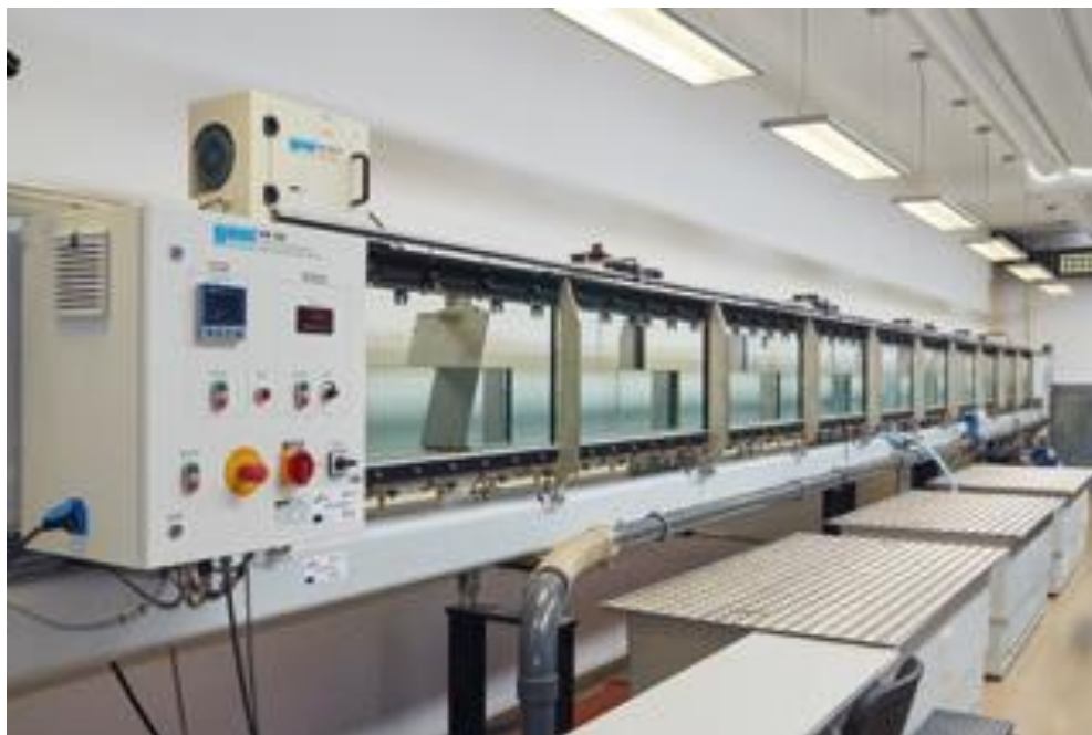
Slika 5.2. Eksperimentalni žlijeb sa hidrotehničkog laboratorija Građevinskog fakulteta u Rijeci unutar kojeg će eksperiment biti proveden (HM 162 Experimental flume) [4]
