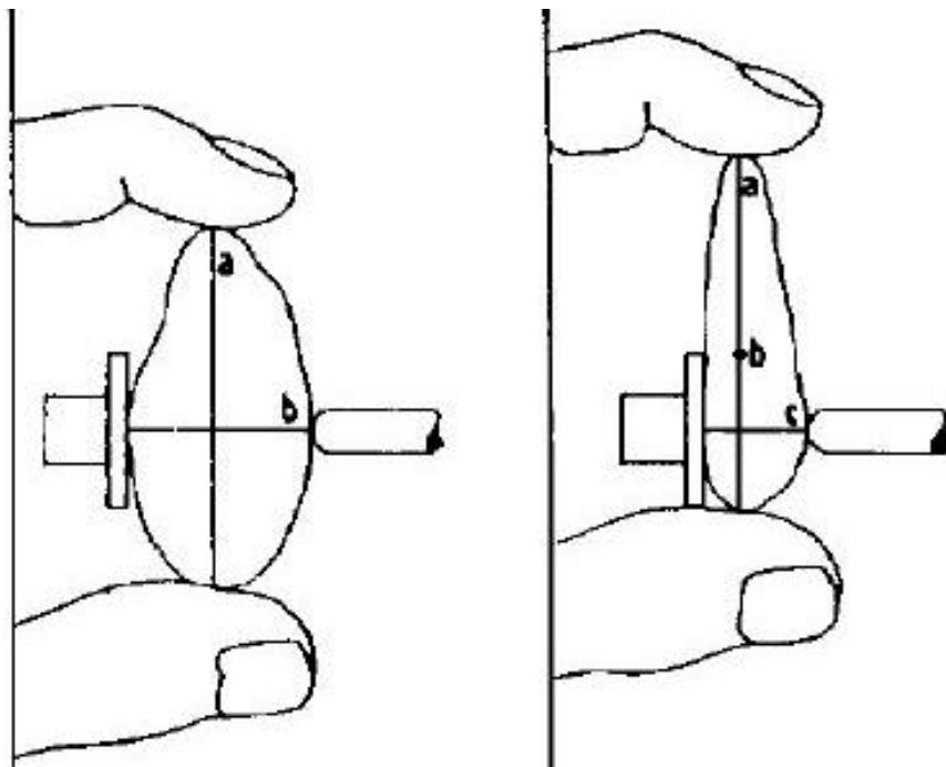
Slika 3.1. Uzorak i primjer mjerena osi a,b i c [7]
