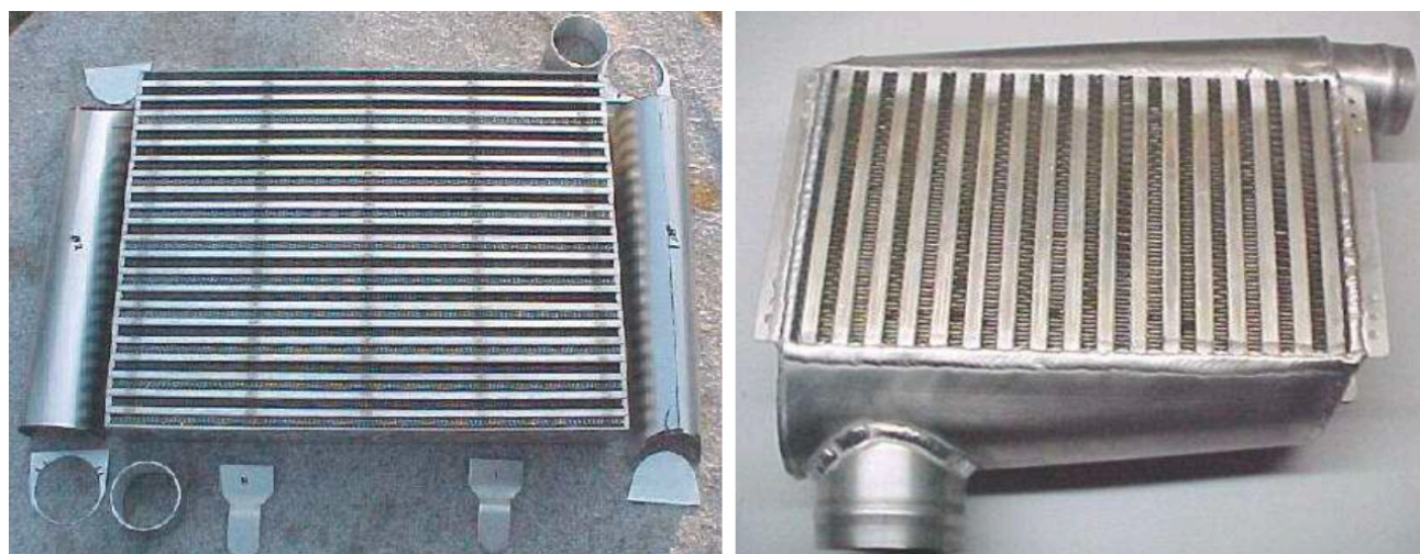
Slika 5.1.1. Izvedbe hladnjaka zraka za prednabijanje [8]
