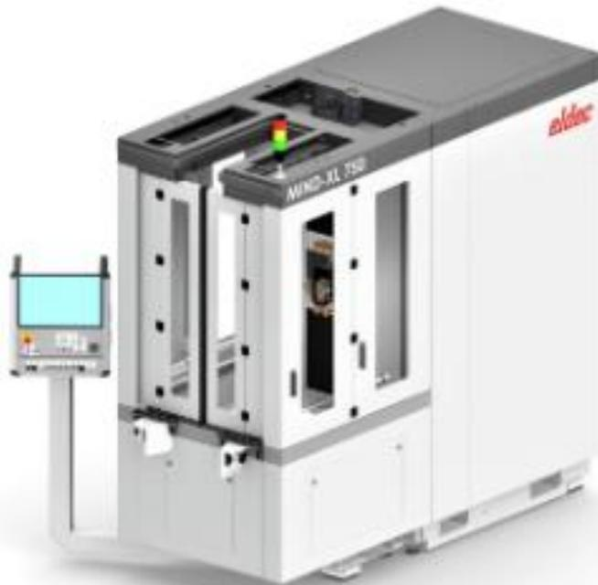
Slika 52 Stroj za induksijsko kaljenje: „ELDEC MIND XL 1500“ [4]
