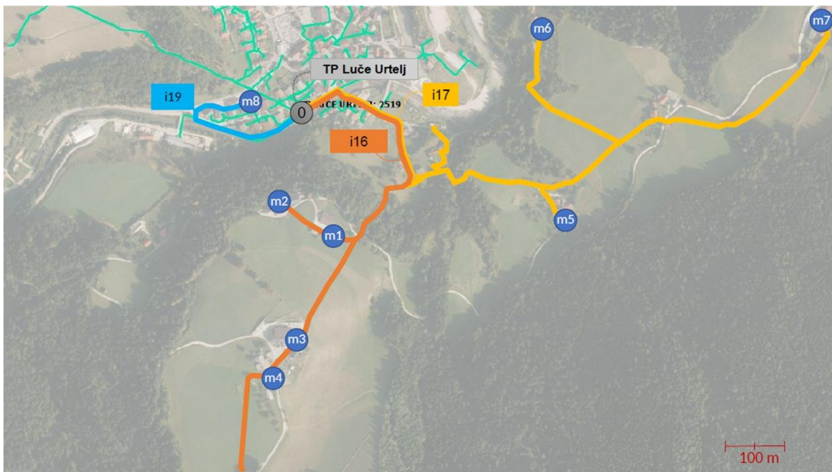
Slika 6.2. Geografski prikaz niskonaponskih izvoda i16, i17 i i19 s označenim točkama promatranja uvjeta. [12]
