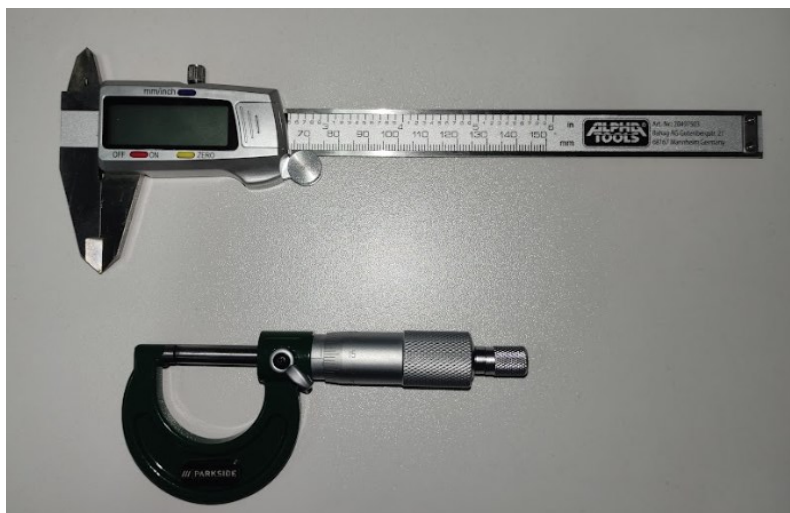
Slika 5.4 Pomično mjerilo i mikrometar
