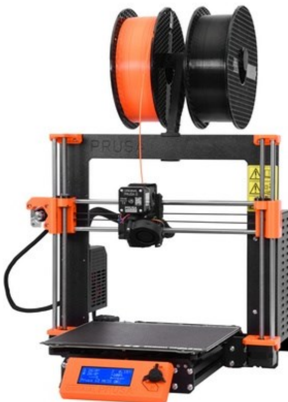
Slika 2.3 Tipičan izgled FDM 3D printera [9]
