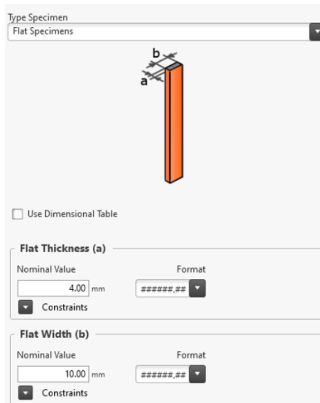
Slika 6.6 Definiranje dimenzija epruvete ( Galdabini LABTEST )
