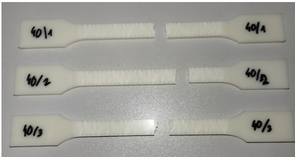
Slika 6.16 Pokidane epruvete s 40% ispune
