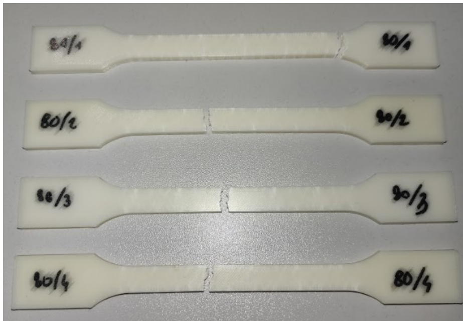
Slika 6.12 Pokidane epruvete s 80% ispune
