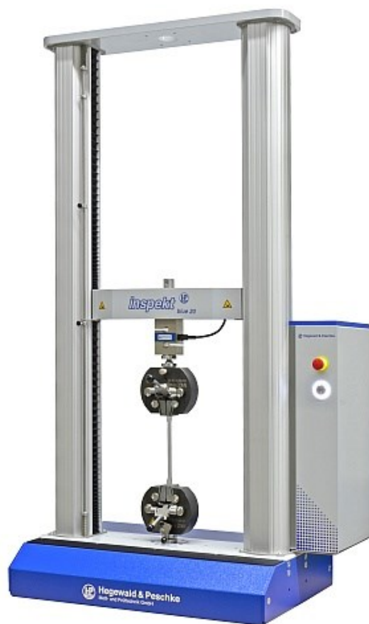
Slika 3.1 Izgled tipične kidalice [19]
