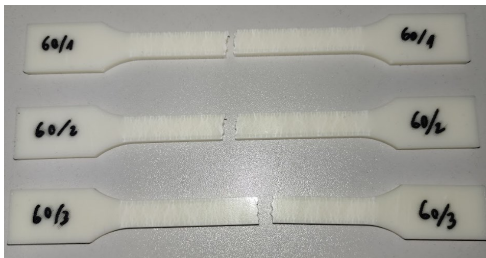
Slika 6.14 Pokidane epruvete s 60% ispune
