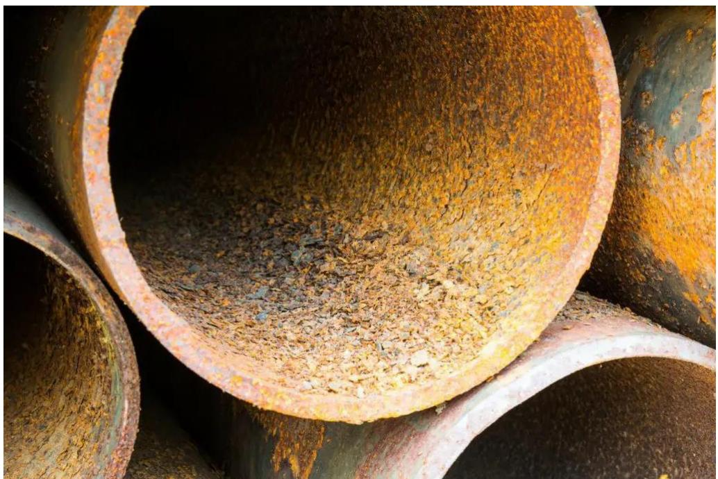
Slika 4.4.1 Primjer unutarnje korozije cijevi
