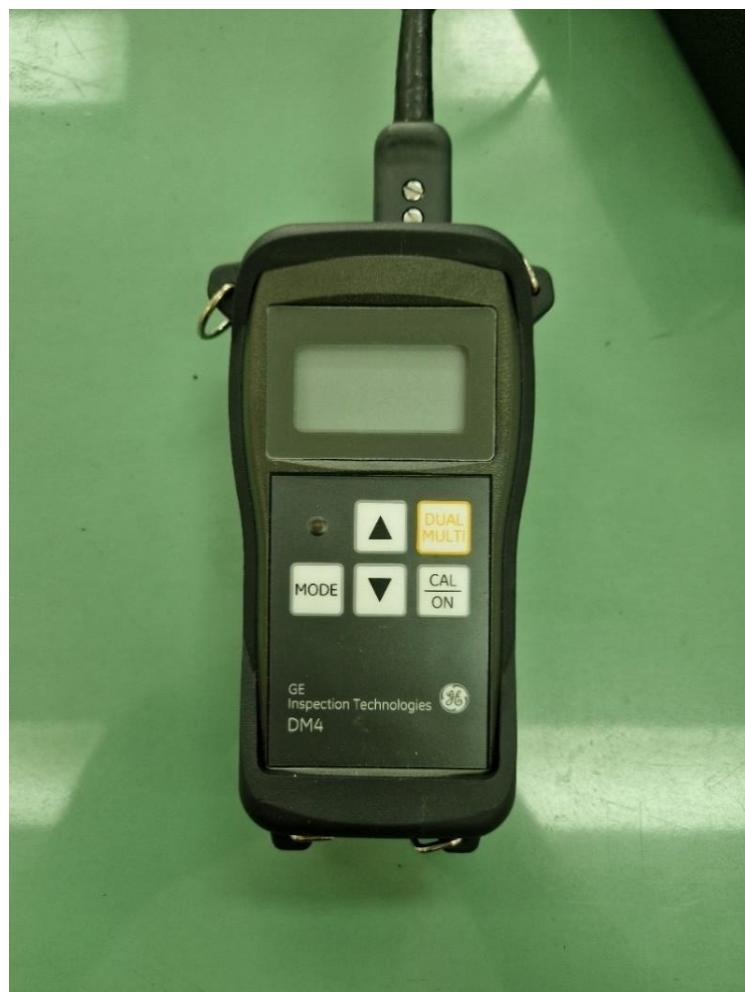
Slika 4.6.1 Ultrazvučni uređaj General Electric DM4
