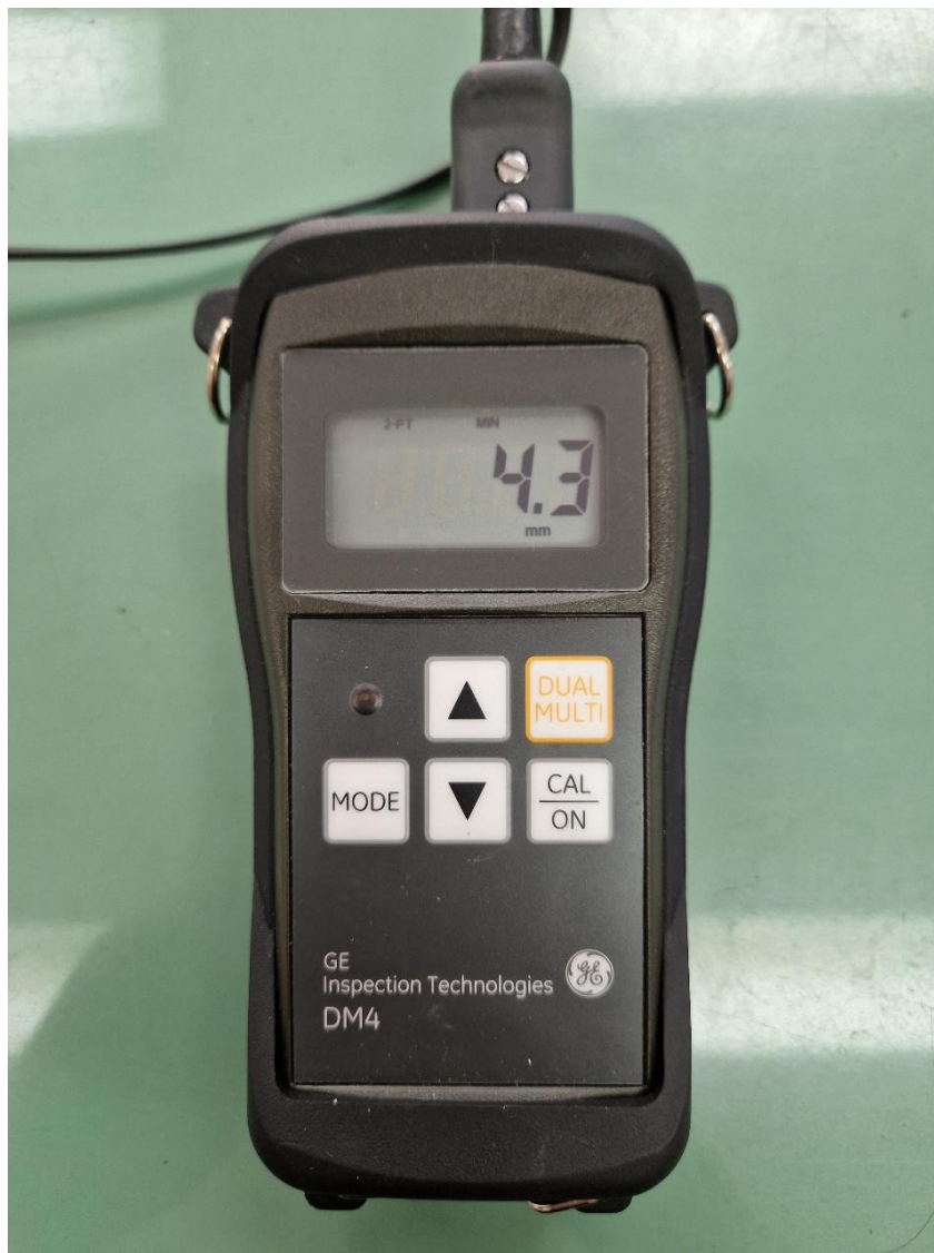
Slika 4.7.1 Rezultat mjerenja debljine cijevi ultrazvukom
