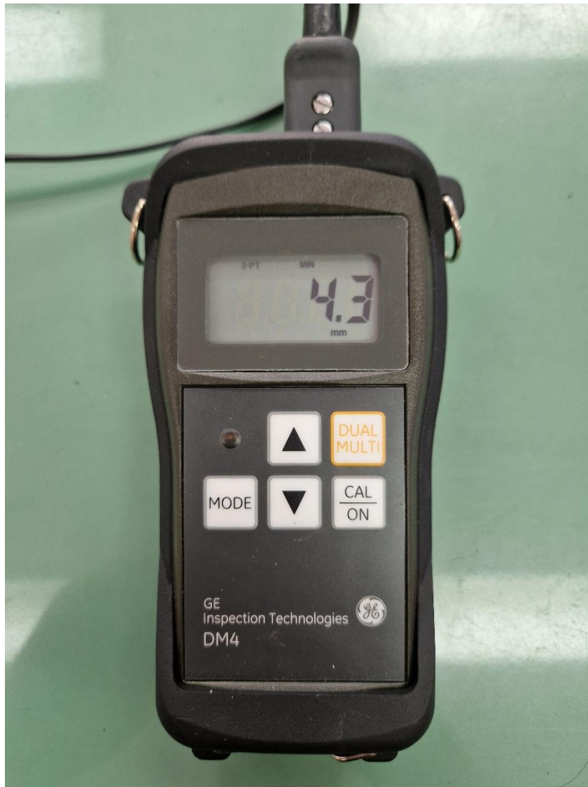
Slika 4.7.1 Rezultat mjerenja debljine cijevi ultrazvukom
