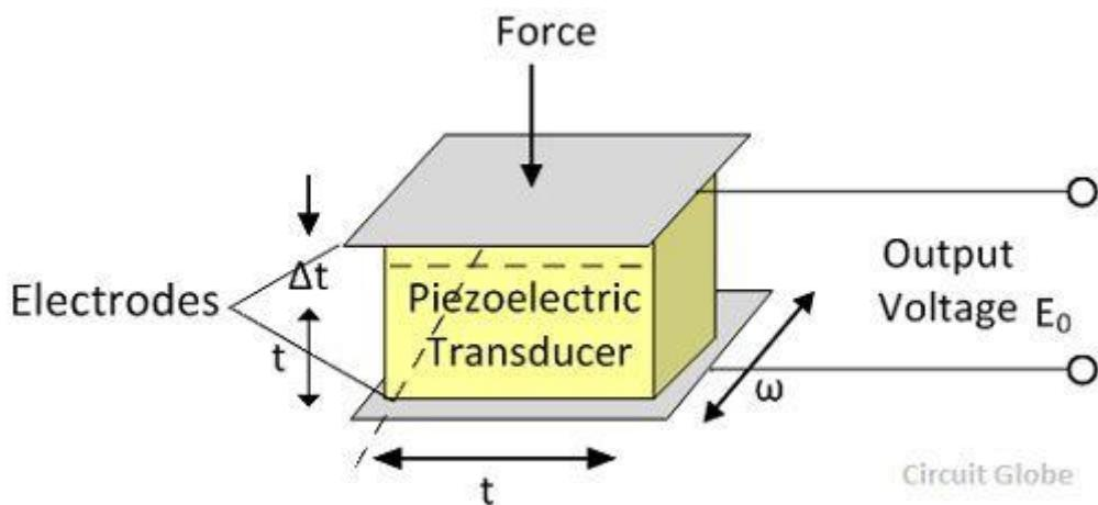
Slika 3.6..1 Piezoelektrični pretvornik
