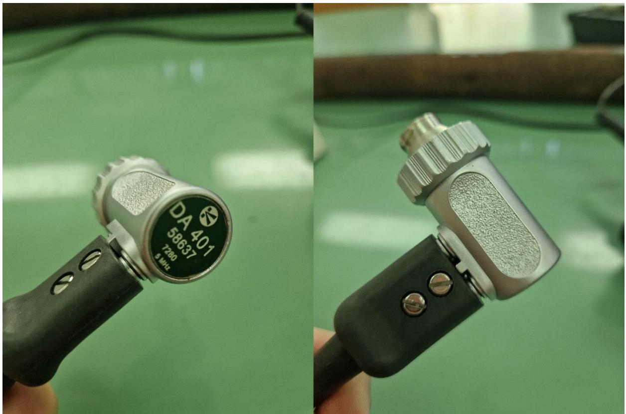
Slika 4.6.2 Ultrazvučna sonda General Electric DA 401
