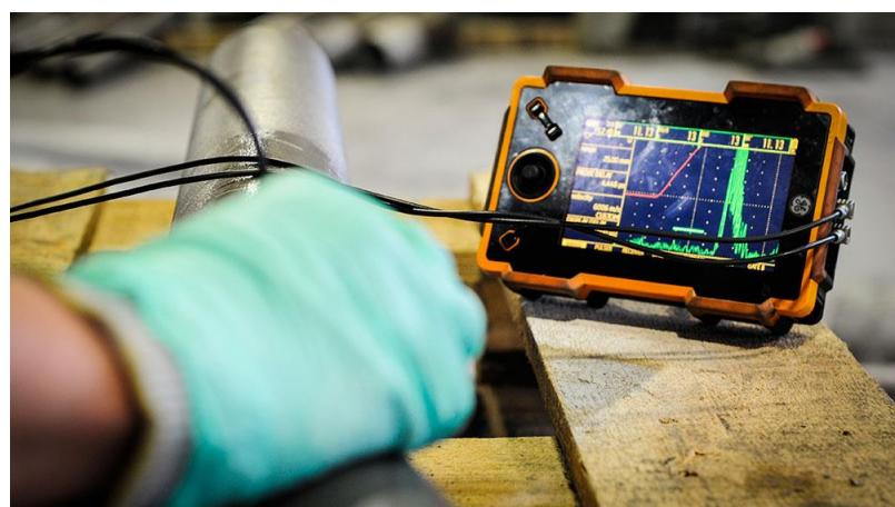
*Slika 2.3.3 Ultrazvučno ispitivanje*
