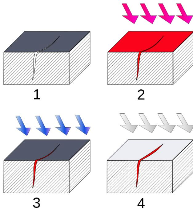
*Slika 2.3.2 Postupak penetrantnog ispitivanja*
