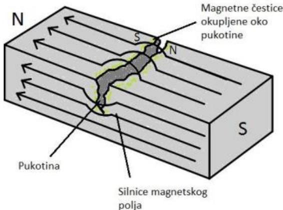
Slika 2.3.1 Silnice magnetskog polja u nailaženju na pukotinu
