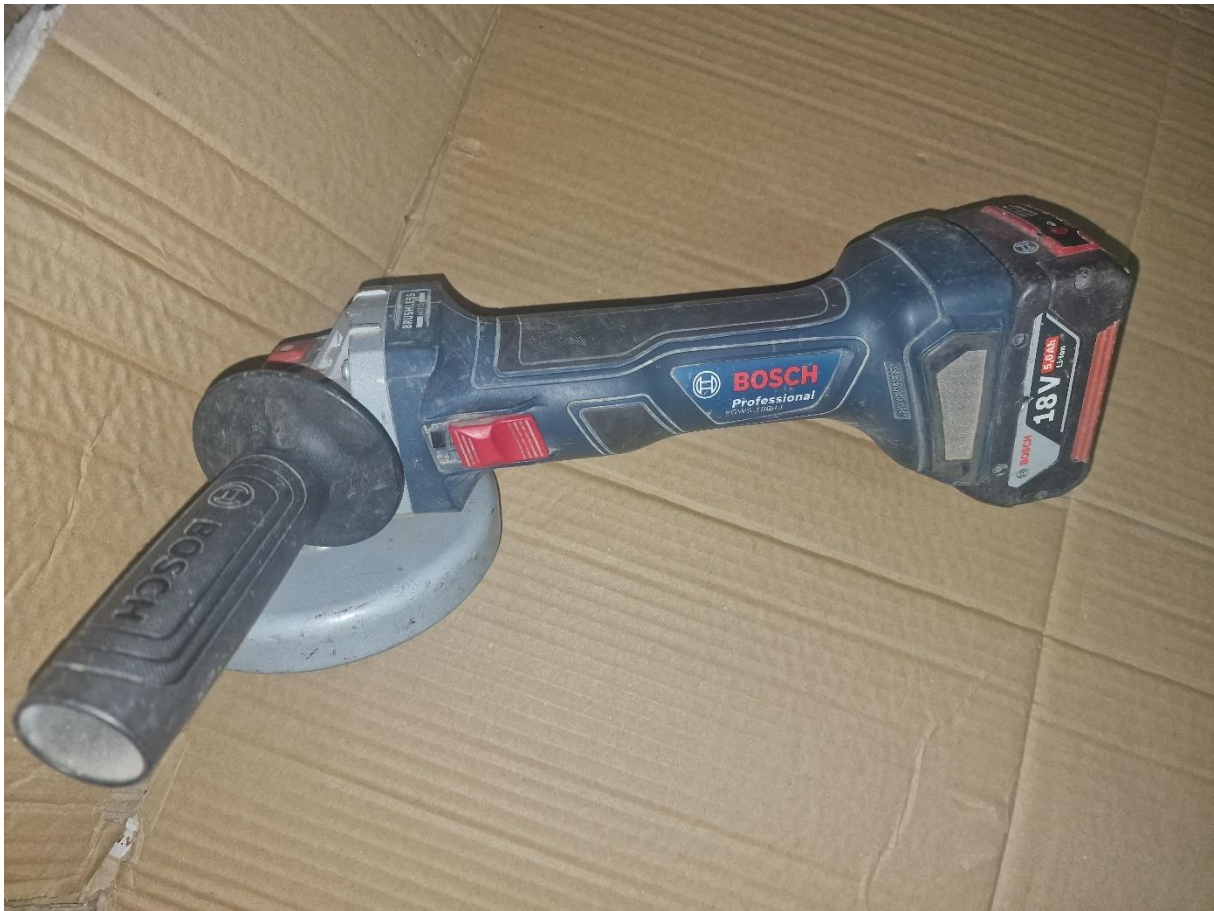
Slika 4.1 Ručna akumulatorska brusilica s BLDC motorom
