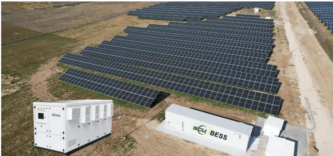
Slika 5. FN elektrana potpomognuta baterijskim sustavom pohrane [11]
