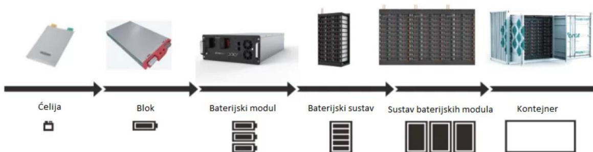
*Slika 5. 16 Sastav baterijskog sustava unutar kontejnera [11]*
