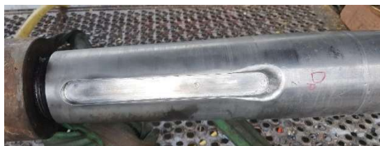
Slika 3.22. Priprema površine konusa brodskog vratila
