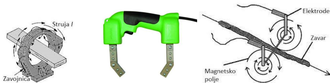
Slika 3.17. Oprema za izvođenje elektromagnetske kontrole
