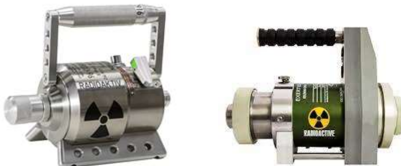
Slika 3.21. Uređaji za gamagrafsku kontrolu
