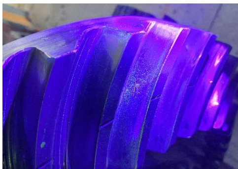
Slika 3.15. Ispitivanje propulzora pod UV svjetlom
