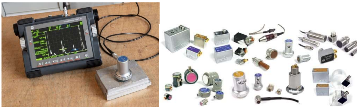
Slika 3.14. Oprema za izvođenje ultrazvučne kontrole
