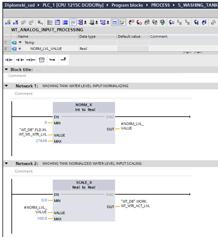
Slika 4.23. Skaliranje ultrazvučnog senzora za mjerjenje razine vode u koritu
