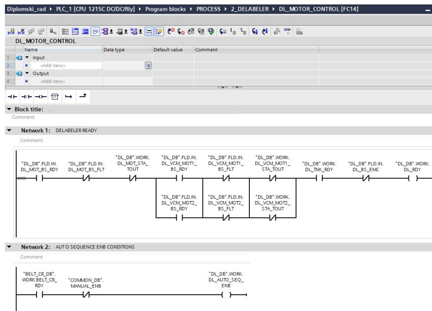
Slika 4.10. Network 1 i 2 upravljanja motorima stroja za skidanje naljepnica
