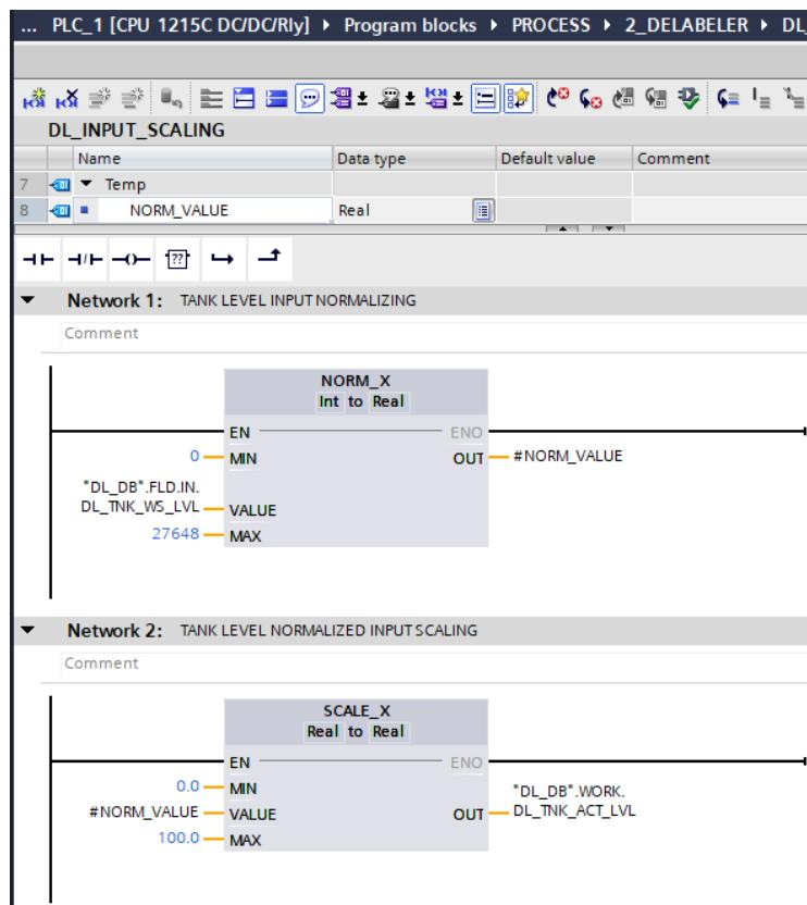
Slika 4.15. Skaliranje ultrazvučnog senzora za mjerjenje razine naljepnica u spremniku
