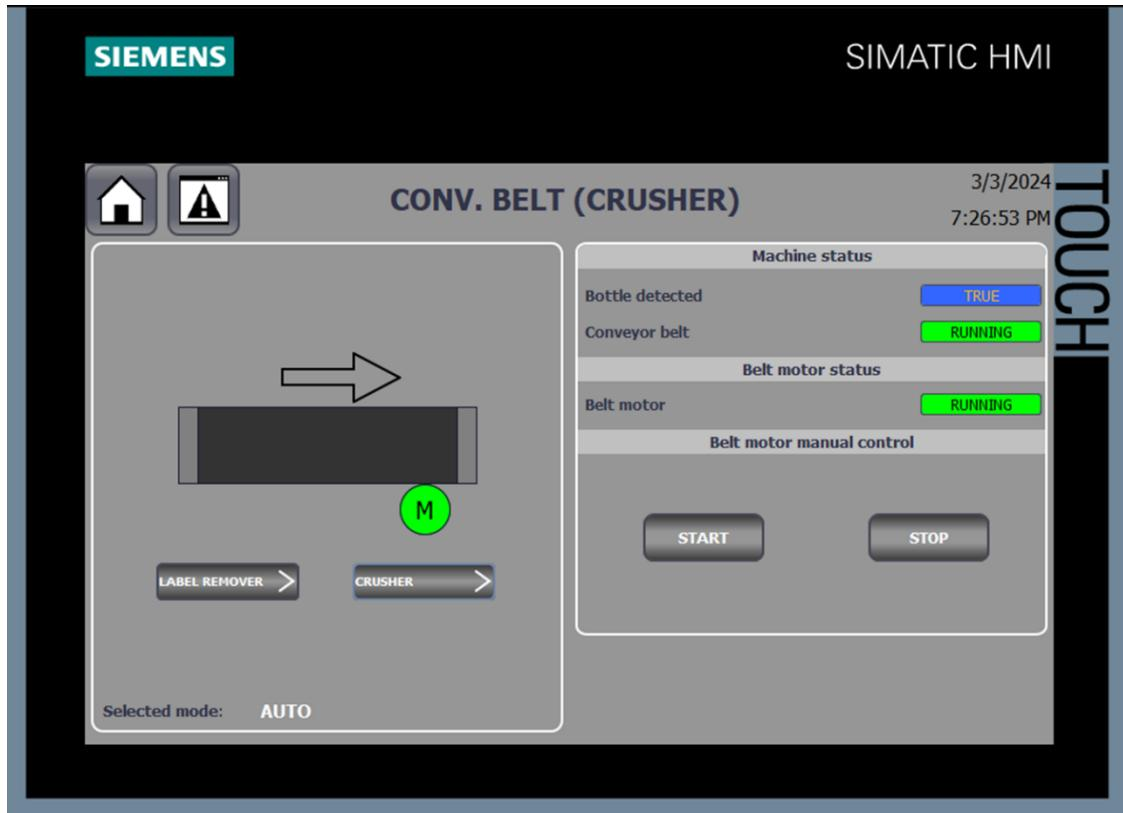
Slika 5.12. HMI prikaz pokretnе trake za prijenos boca od stroja za skidanje naljepnica do drobilice
