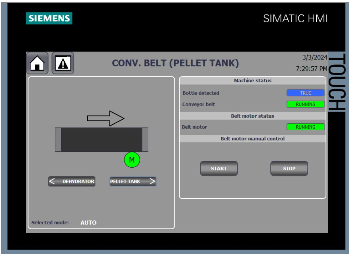
Slika 5.17. HMI prikaz pokretnе trake za prijenos komadića plastike od dehidratora do spremnika za skladištenje
