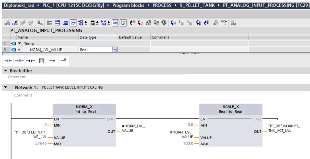
Slika 4.40. Skaliranje ultrazvučnog senzora za mjerjenje razine komadića plastike u spremniku
