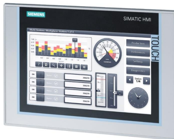
Slika 3.4. HMI zaslon TP900 Comfort [26]
