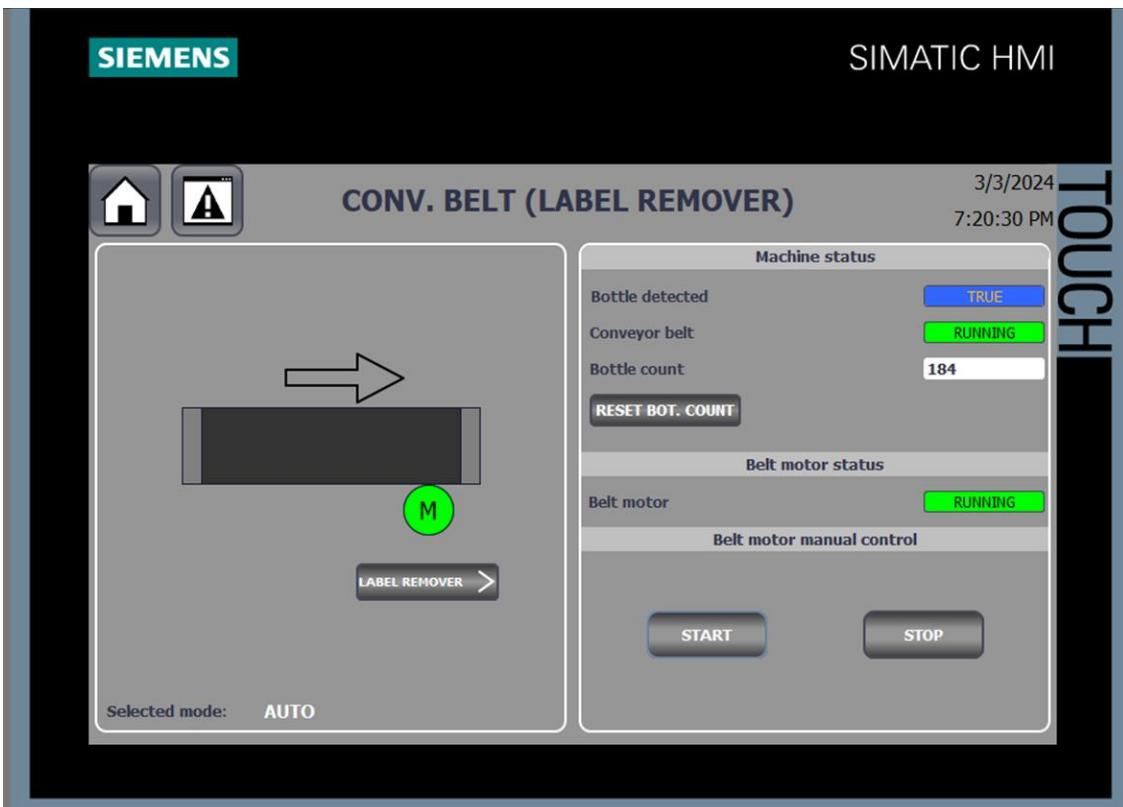
Slika 5.10. HMI prikaz pokretnе trake za prijenos boca do stroja za skidanje naljepnica
