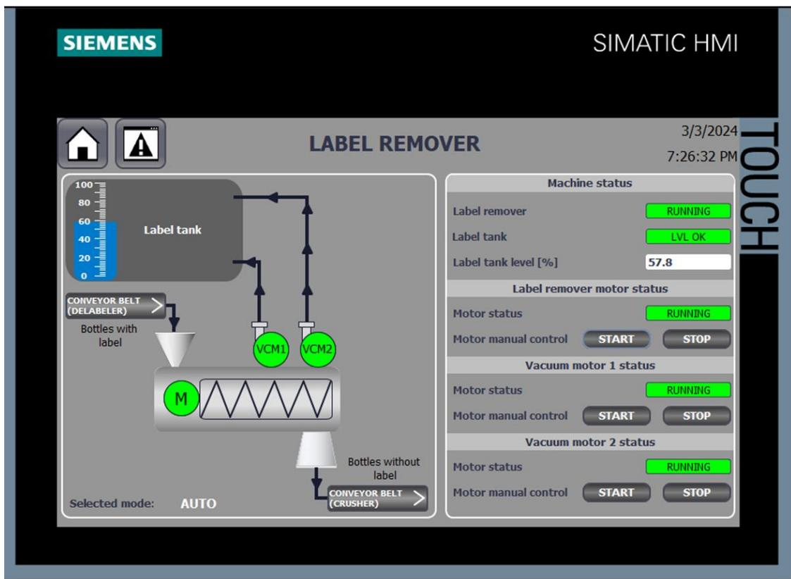
Slika 5.11. HMI prikaz stroja za skidanje naljepnica
