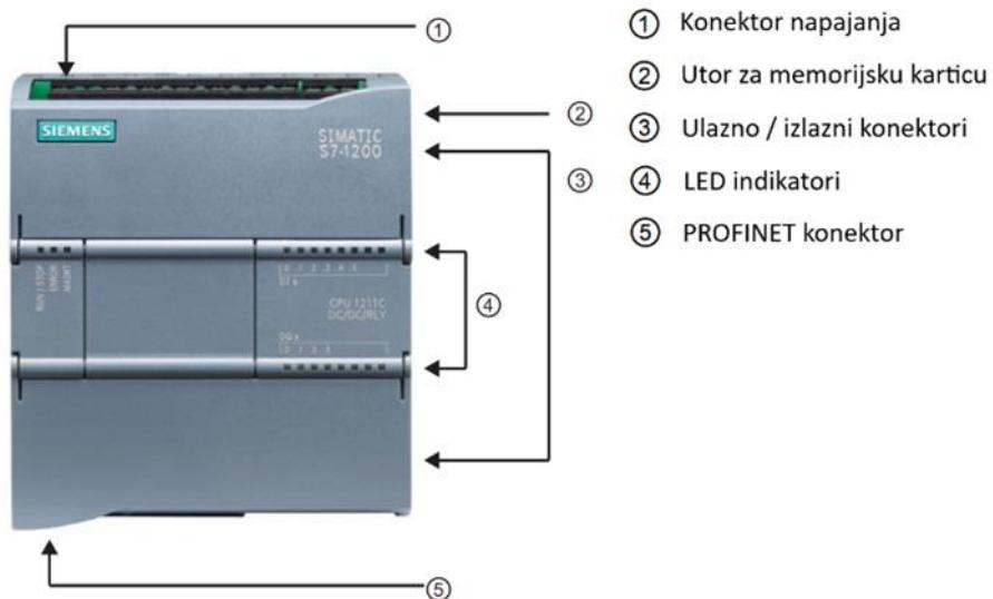
Slika 3.1. Siemens S7-1200 PLC [22]
