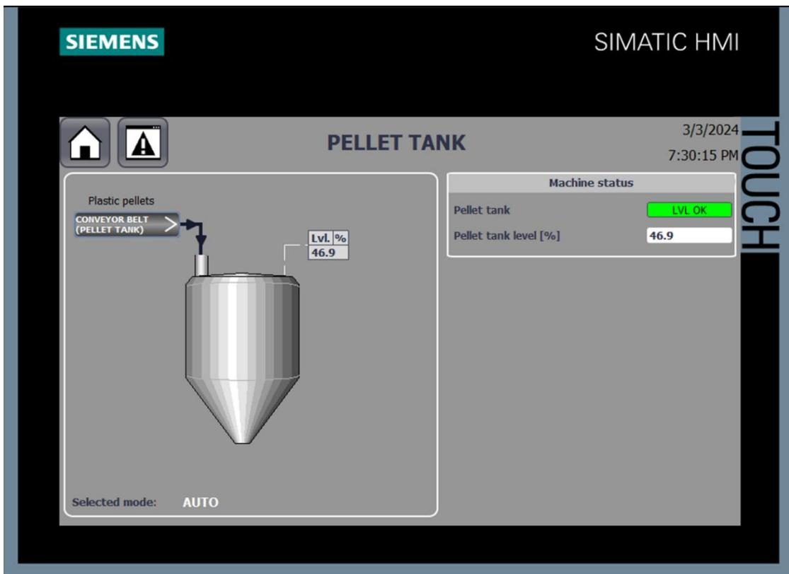
Slika 5.18. HMI prikaz spremnika za skladištenje komadića plastike
