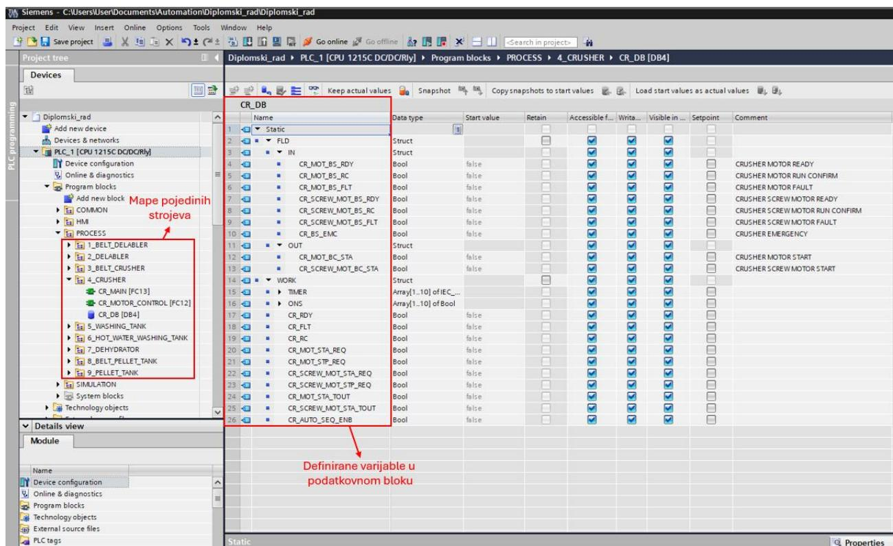
Slika 4.5. Kreirane mape strojeva i podatkovni blok drobilice
