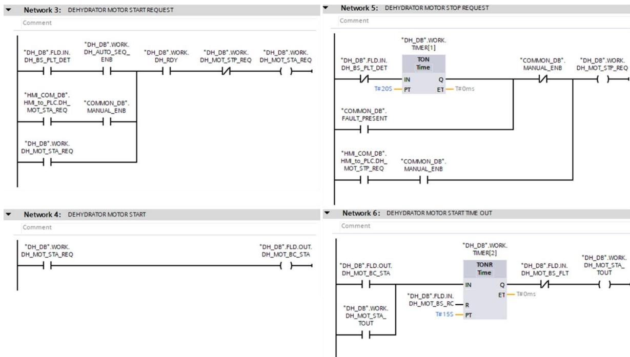
Slika 4.38. Network 3 – 6 upravljanja motorom dehidratora
