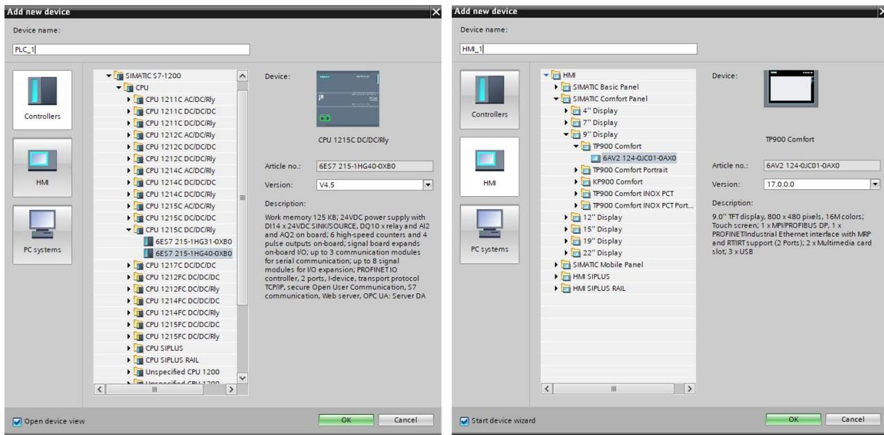
Slika 4.1. Odabir PLC-a (lijevo) i HMI zaslona (desno)
