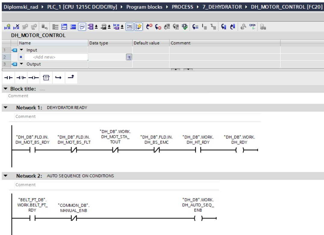
Slika 4.37. Network 1 i 2 upravljanja motorom dehidratora
