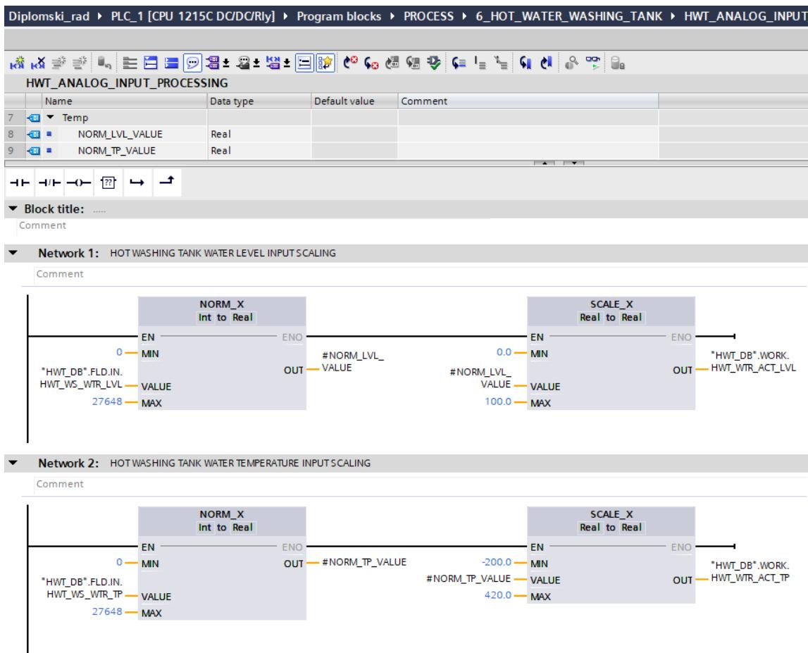
Slika 4.31. Skaliranje ultrazvučnog senzora i Pt100 sonde
