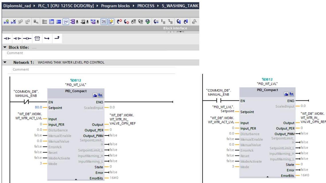
Slika 4.24. PID Compact funkcijiski blok
