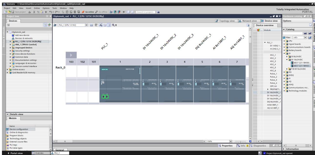
Slika 4.2. Hardverska konfiguracija PLC-a i dodatnih I/O modula
