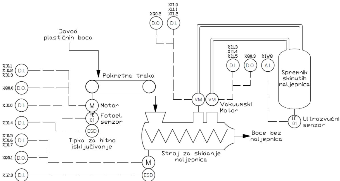
Slika 2.2. P&ID dijagram pokretnе trake i stroja za skidanje naljepnica
