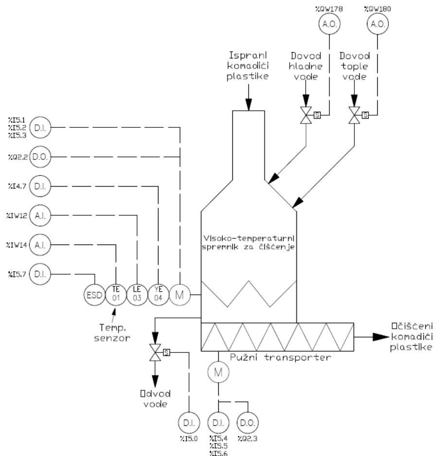
Slika 2.5. P&ID dijagram visoko-temperaturnog spremnika za čišćenje
