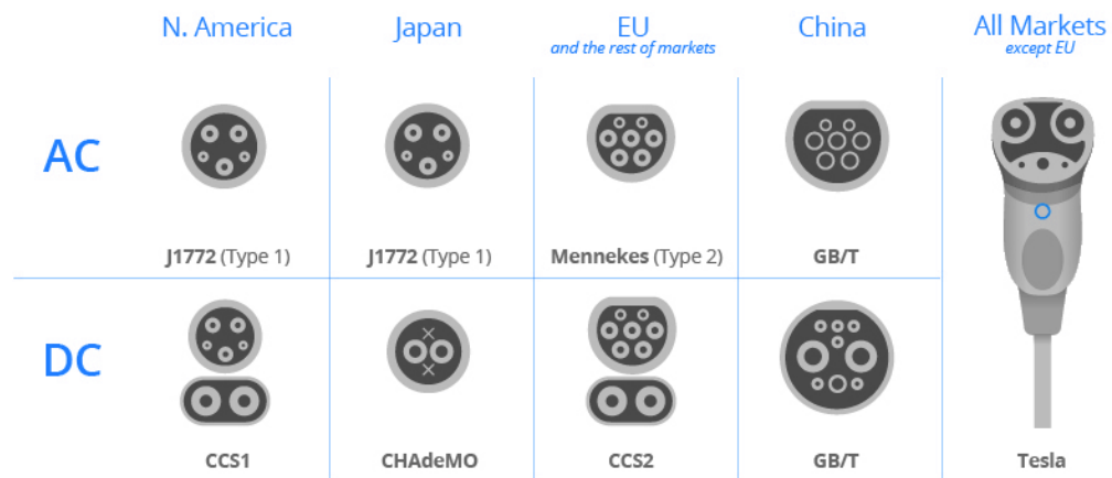
Slika 2.9 Različiti tipovi konektora u svijetu
