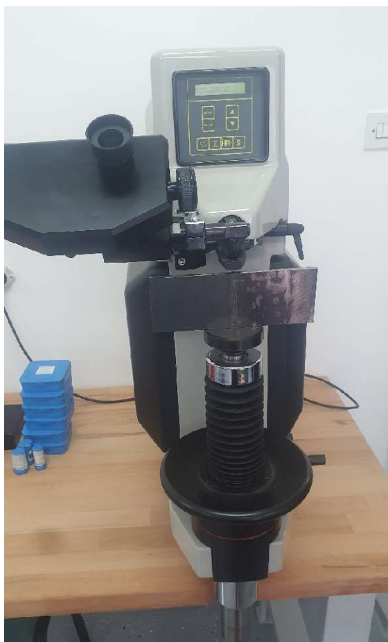
Slika 20 Uređaj za mjerenje tvrdoće zavara.
