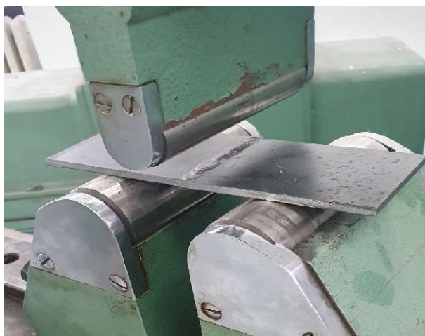
Slika 19 Ispitivanje zavarana savijanje
