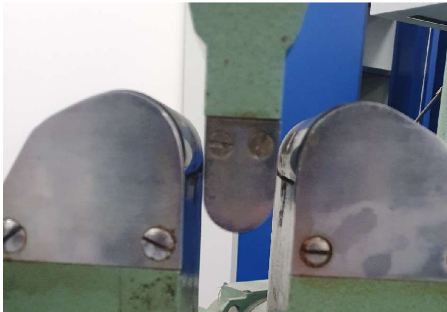
Slika 26 Namještena kidalica prema normi DIN EN 910
