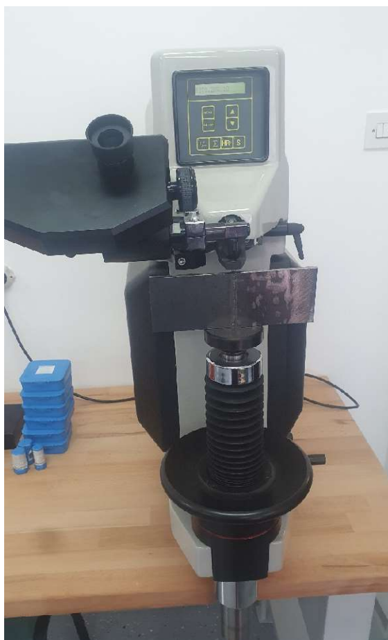
Slika 20 Uređaj za mjerenje tvrdoće zavara.
