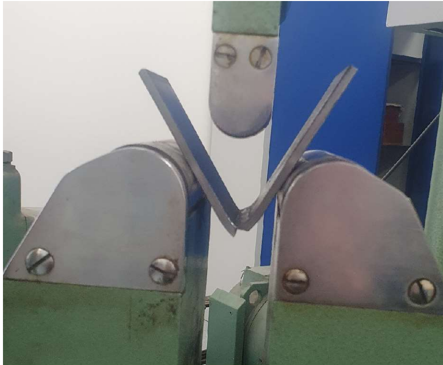
Slika 31 Pucanje uzorka 4 u kidalici
