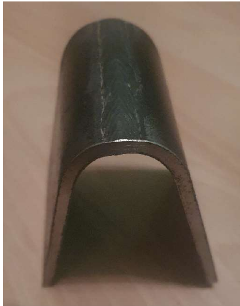
Slika 27 Uzorak 1 savijanje preko čela zavara
