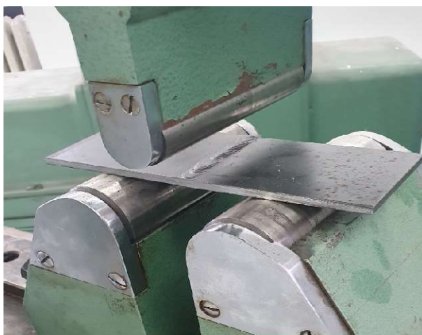
Slika 19 Ispitivanje zavarana savijanje
