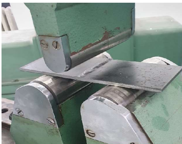
Slika 19 Ispitivanje zavarana savijanje
