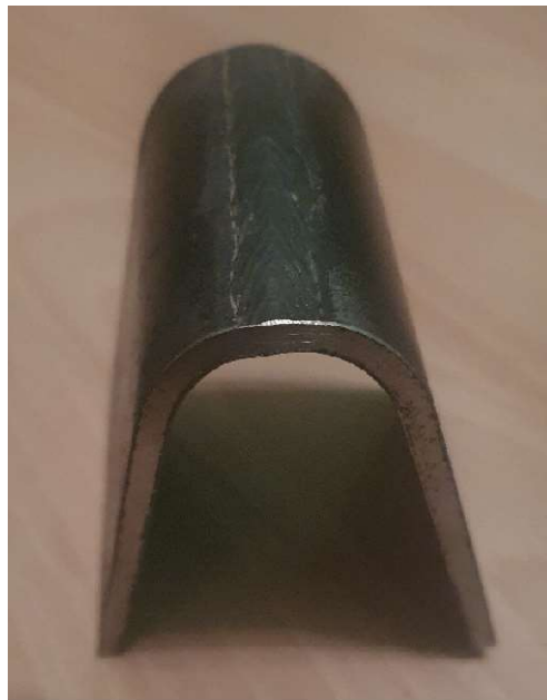
Slika 27 Uzorak 1 savijanje preko čela zavara
