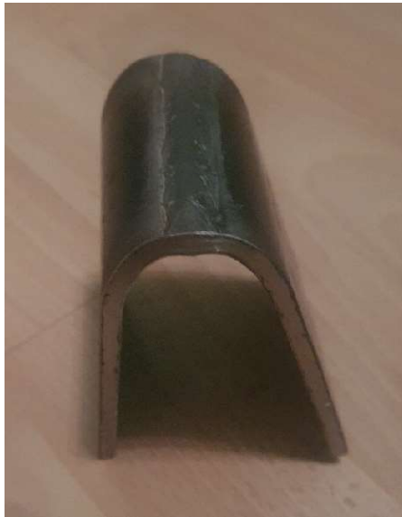
Slika 27 Uzorak 1 savijanje preko čela zavara
