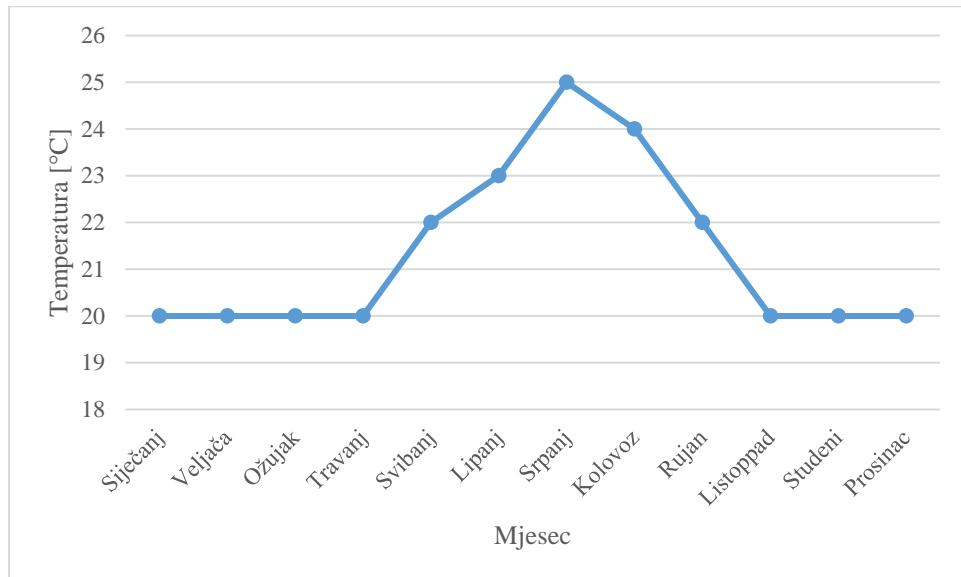
**Slika 2.9: Mjesečni raspored temperature bočnih zidova**
