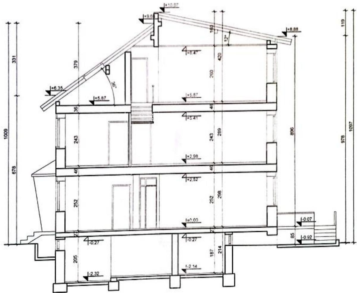
*Slika 2.6: Poprečni presjek kuće*
