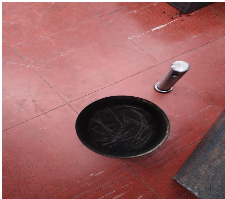
Slika 4.5. Posuda za pougljičavanje i strojni dio
