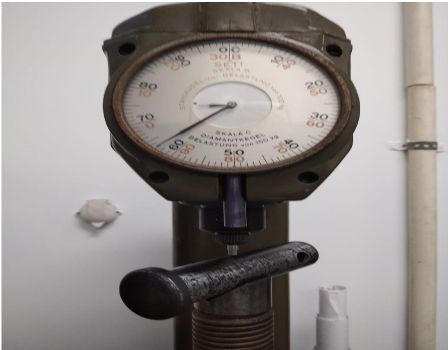
Slika 4.10. Ispitivanje tvrdoće prije niskotemperaturnog popuštanja ( 63 HRC )
