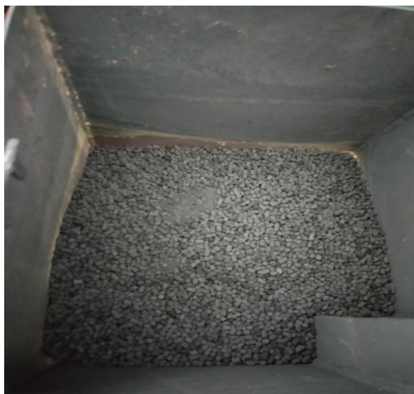
Slika 4.6. Ugljični granulat za cementiranje
