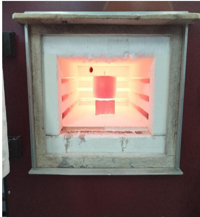
Slika 4.8. Hlađenje nakon pougljičavanja
