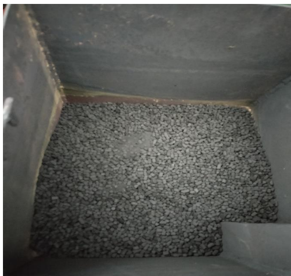
Slika 4.6. Ugljični granulat za cementiranje
