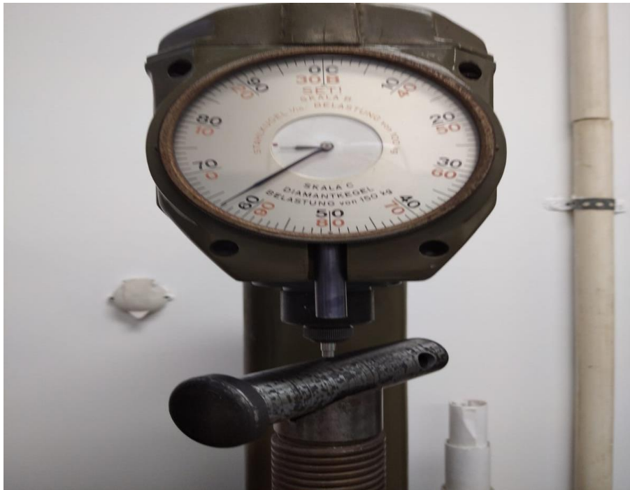
Slika 4.10. Ispitivanje tvrdoće prije niskotemperaturnog popuštanja ( 63 HRC )
