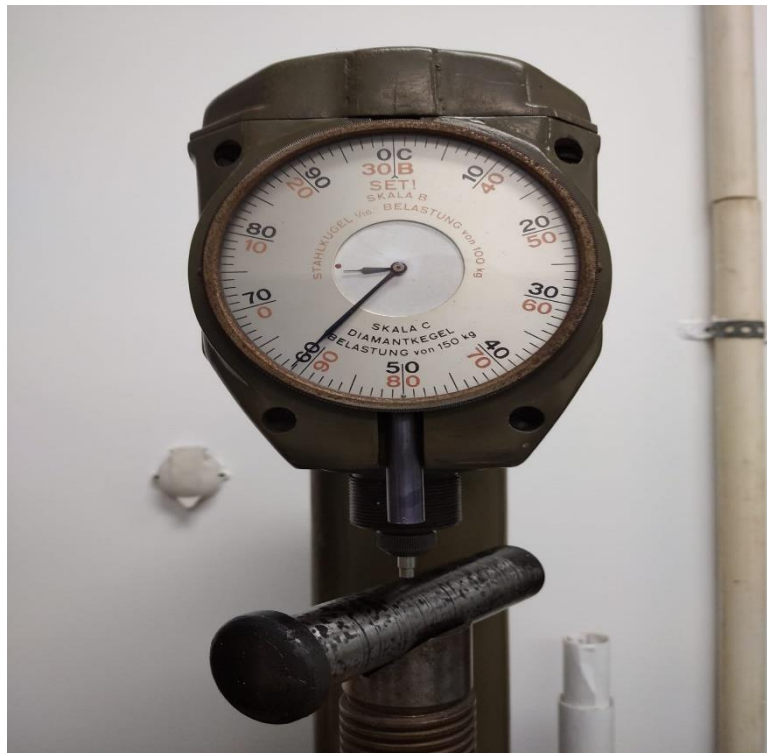
Slika 4.11. Ispitivanje tvrdoće poslije niskotemperaturnog popuštanja (61 HRC)
