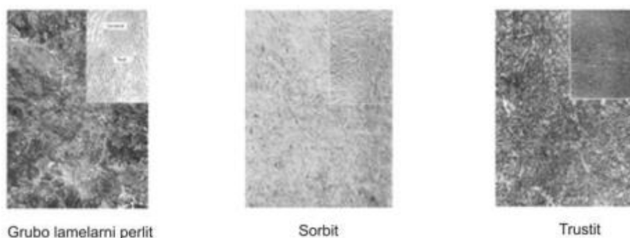
Slika 2.11. mikrostruktura perlita, sorbita te trustita [10]
