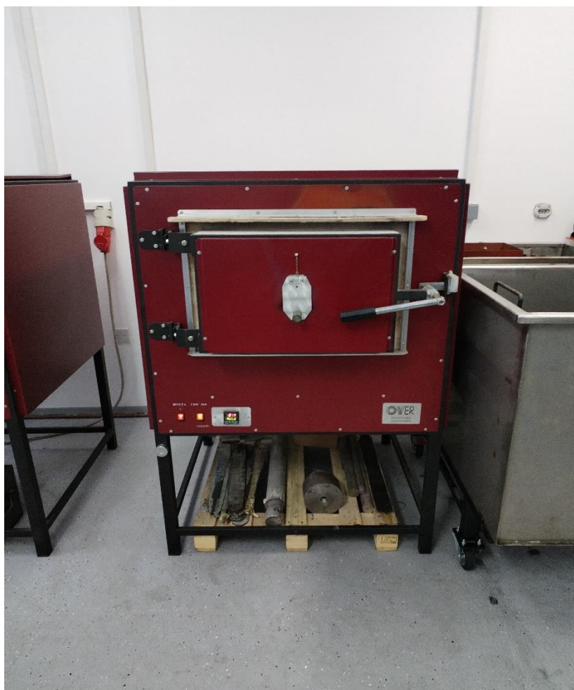
Slika 4.7. Peć za toplinsku obradu marke „OVER“
