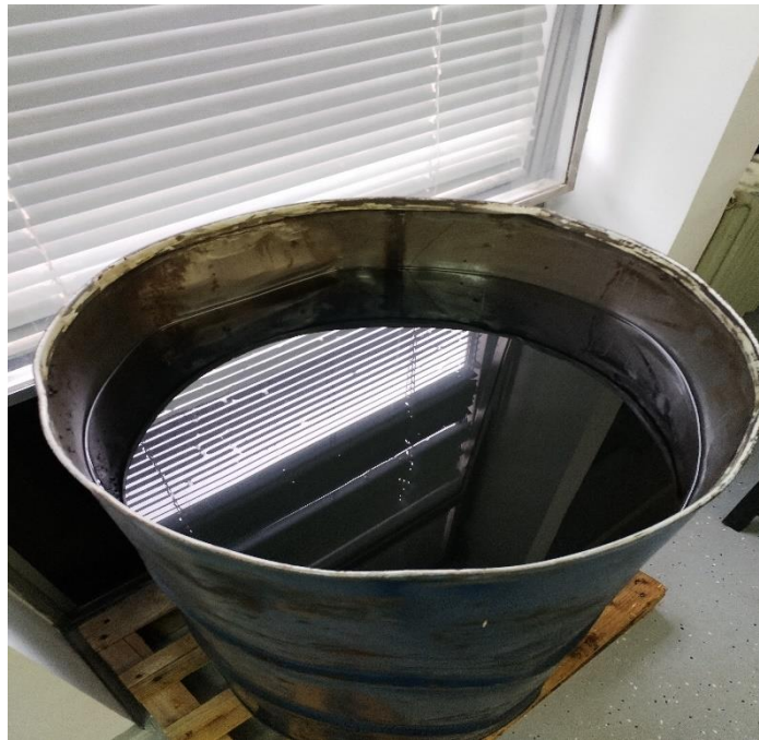
Slika 4.9. INA KALENOL 22 ulje za gašenje strojnog dijela
