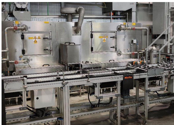
Slika 4.5 Namjenska protočna perilica – prednja strana
