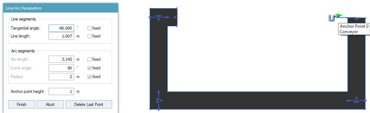
Slika 4.33 Postavke i izgled definiranog objekta Conveyor
