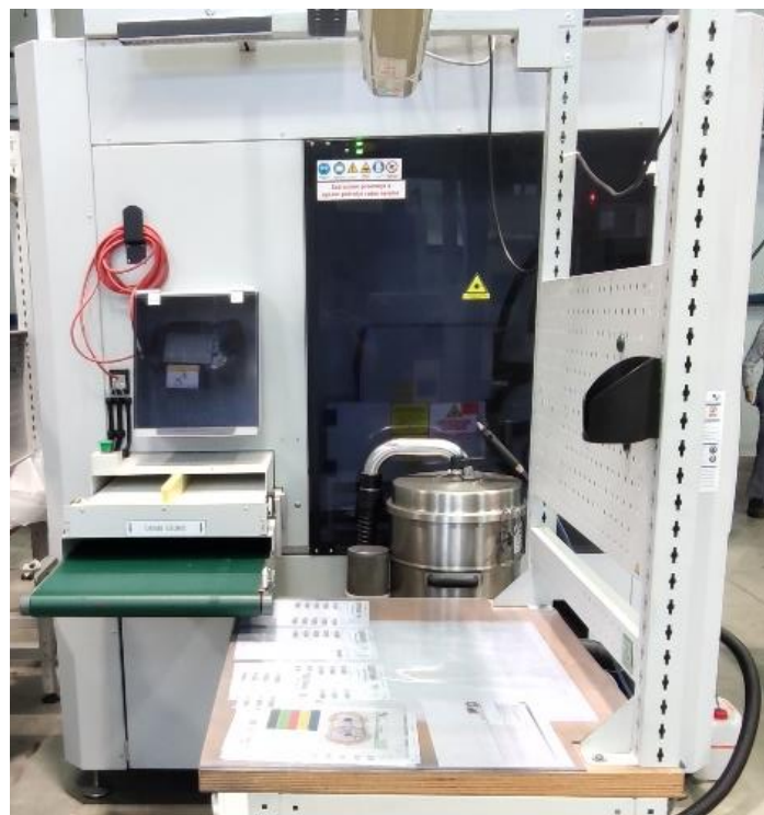
Slika 4.15 Namjenski uređaj za test propusnosti
