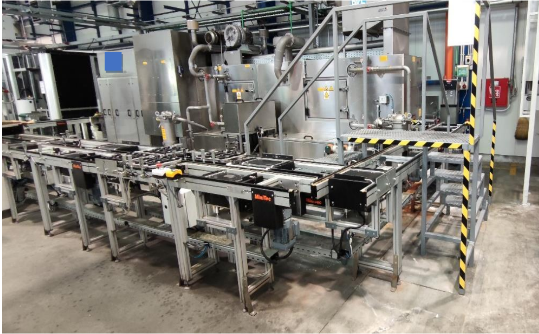
Slika 4.6 Namjenska protočna perilica, pokretna traka i prijelaz za servisiranje
