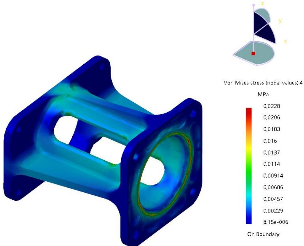
Slika 8.11 Naprezanja po Von Mises-u za os y
