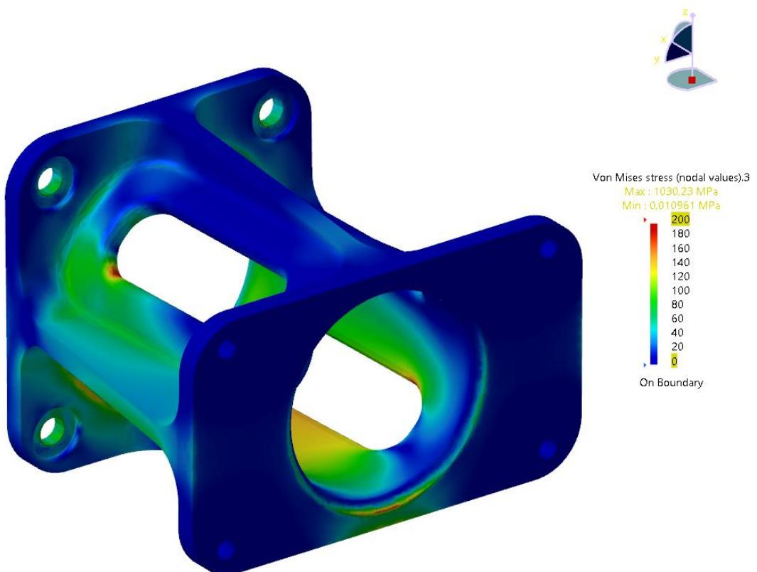
Slika 6.3 Prikaz ekvivalentnih naprezanja po Von Mises-u
