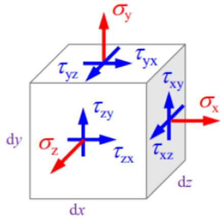
Slika 2.7 Troosno stanje naprezanja infintizimalnog elementa [1]
