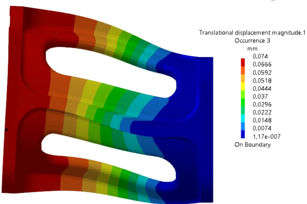
Slika 7.6 Treći slučaj izvijanja
