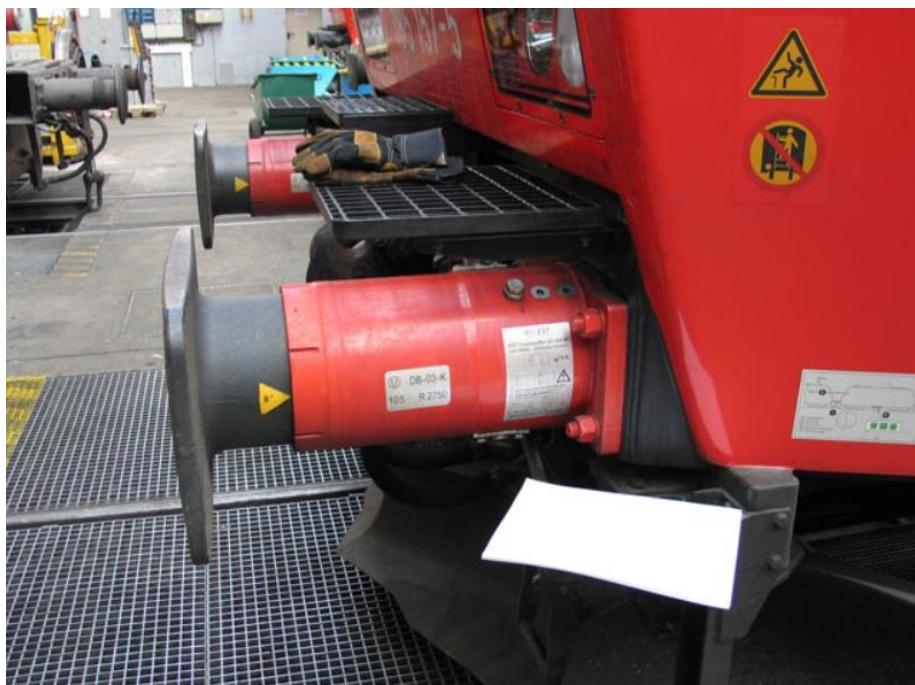
Slika 5.2 Prikaz odbojnika udara na željezničkom vagonu [9]
