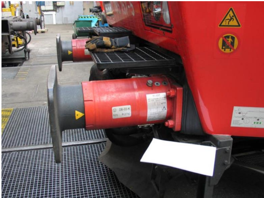
Slika 5.2 Prikaz odbojnika udara na željezničkom vagonu [9]
